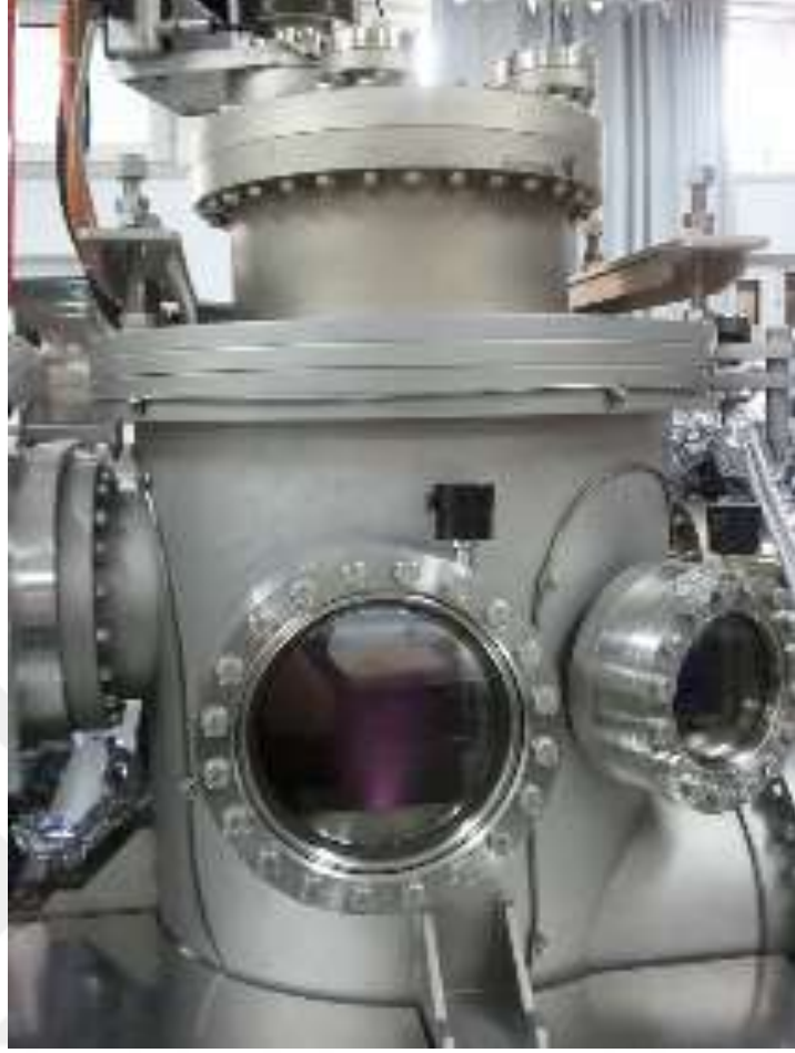
Şekil 3.2 Kaplama için kullanılan sıçratma odacığı. VO x film üretimi sırasında oluşan plazma (mor renkte) görülmektedir.
