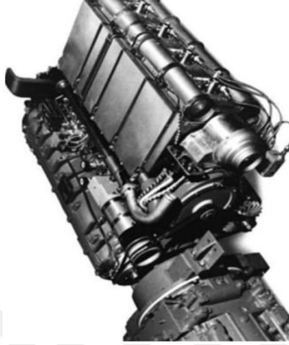
Resim 2.2 Philips firmasına ait 4-235 modeli Stirling motoru (Erol 2011).
