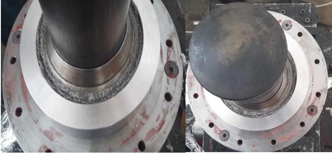
Resim 5.1 Rejeneratör bölgesinin görünümü .
