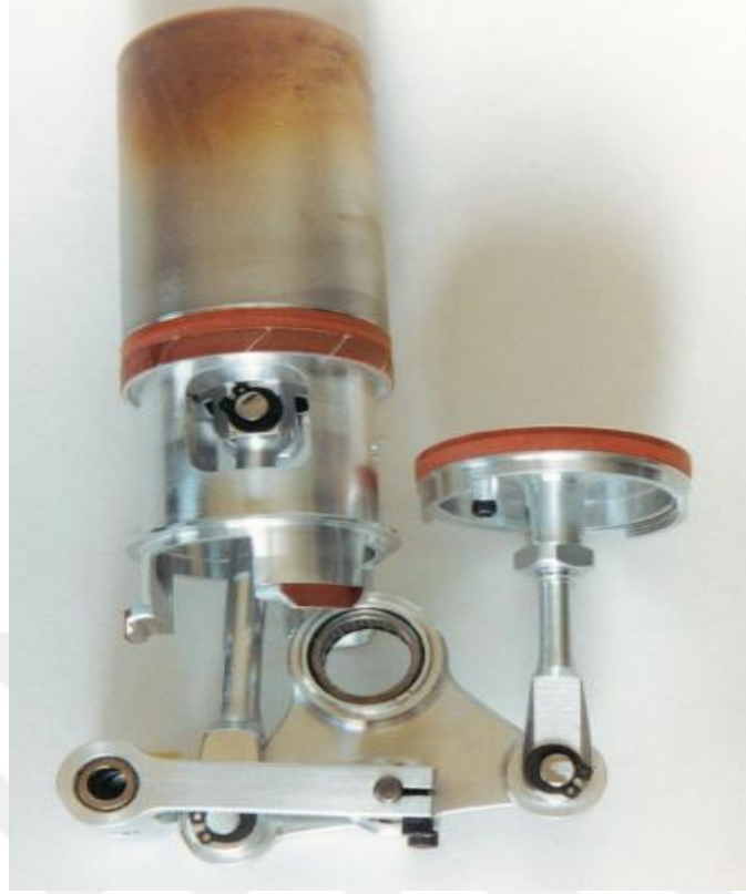
Resim 2.3 Ross Yoke hareket iletim mekanizması (Erol 2011).
