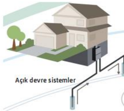
Şekil 2.4 Açık Çevrimli Toprak Kaynaklı Isı Değıştiricisi Örneğı [63]
