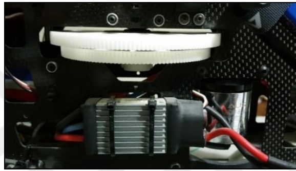
Şekil 3.35. Fırçasız motor ve ESC yerleşimi
