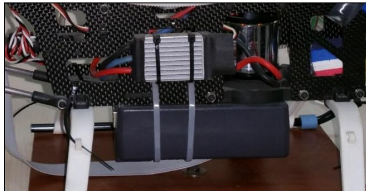
Şekil 3.41. Kontrol biriminin (arduino) helikopter üzerinde gösterimi
