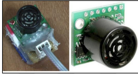
Şekil 3.17. Ultrasonic mesafe sensörü gösterimi
