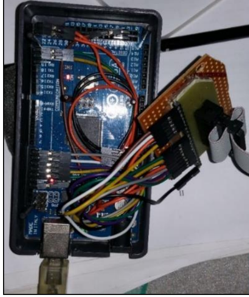
Şekil 3.42. Arduino ile kontrol üniteleri bağlantısı
