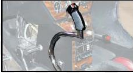
Şekil 3.13. Cyclic kontrol ünitesi
