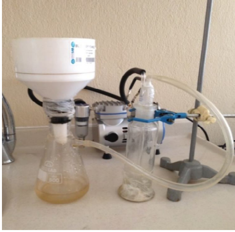
Vakumlu pompa düzeneği
