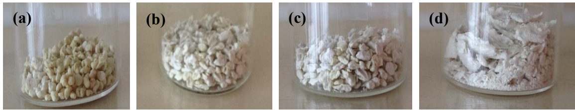
Şekil 3.5. Farklı kitosan/perlit oranlarında elde edilmiş (Kts/P) kompozit kürelerinin kurutulmuş halleri a) 1:0.5 b) 1:0.75 c) 1:1 d) 1:2 g /g
