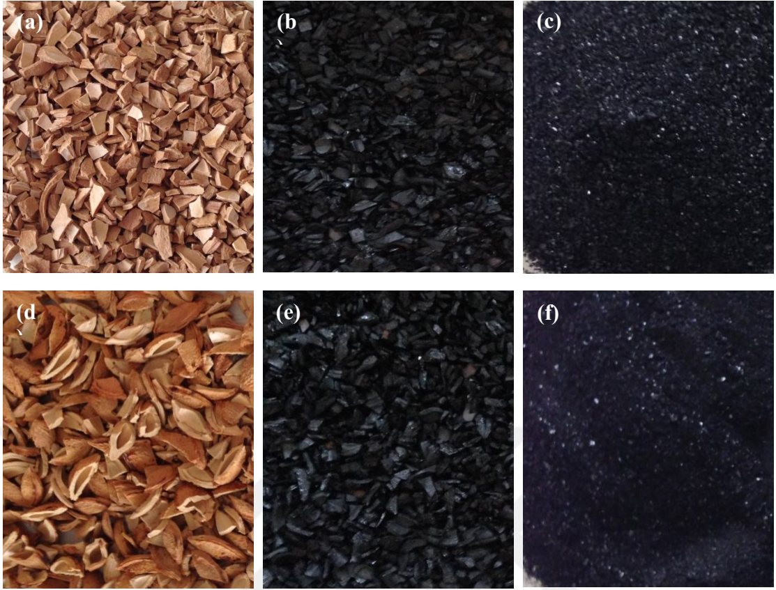
Şekil 3.26. a) (KÇK) b) (KÇK) emdirme işleminden sonra karbonizasyon işleminden önceki hal c) (KÇAK) d) (EÇK) e) (EÇK) emdirme işleminden sonra karbonizasyon işleminden önceki hal f) (EÇAK)
