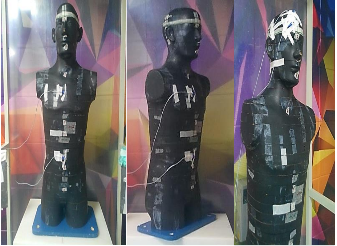
Resim 3.14. Diyot dedektör ile doz ölçümü.
