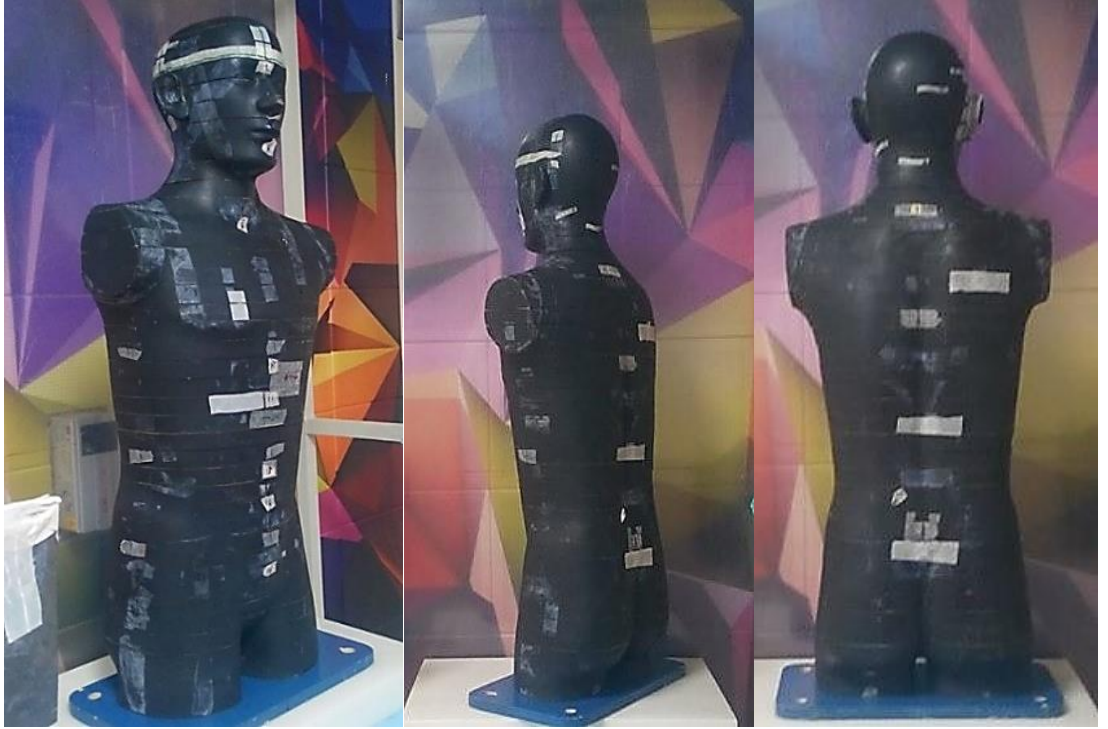
Resim 3.15. TLD ile doz ölçümü.
