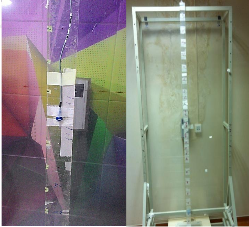
Resim 3.10. TLD ve diyot dedektör ile doz profil ölçümü.
