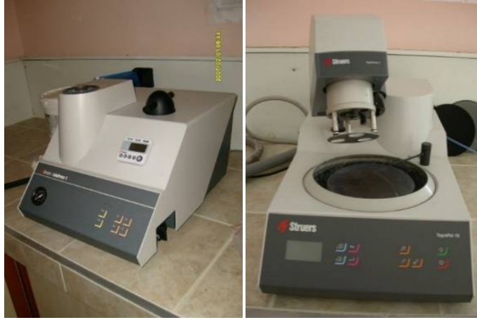
Şekil 5.16: (a) Struers TM Labopressbakalite alma cihazı. (b) Struers TM Tegrapol-15 parlatma cihazı.
