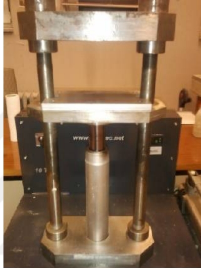
Şekil 5.11: MSE tek eksenli hidrolik el presi.
