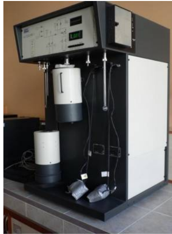
Şekil 5.8: Quanthachrome™ Autosorb Yüzey Alanı veGözeneklik Ölçüm Cihazı.
