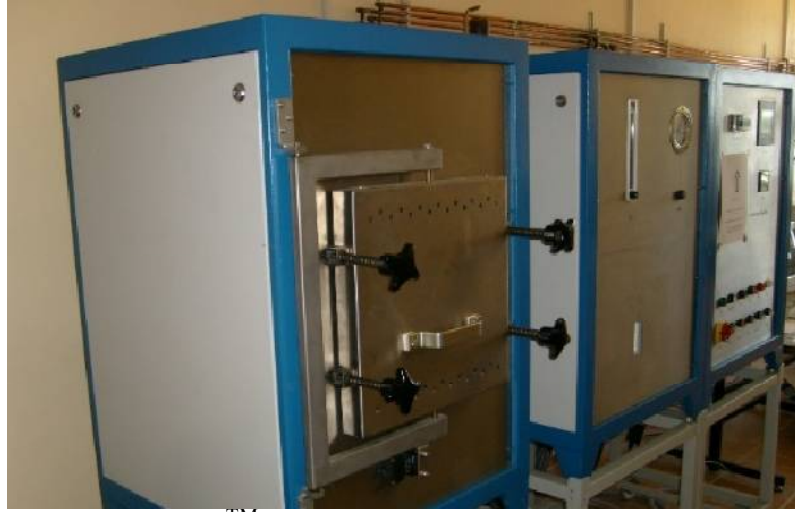
Şekil 5.14: Linn™ 1800 M Vac kontrollü atmosfer sinter fırını.
