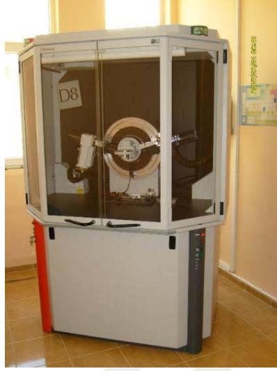
Şekil 5.5: Bruker™ D8 Advance difraktometresi.
