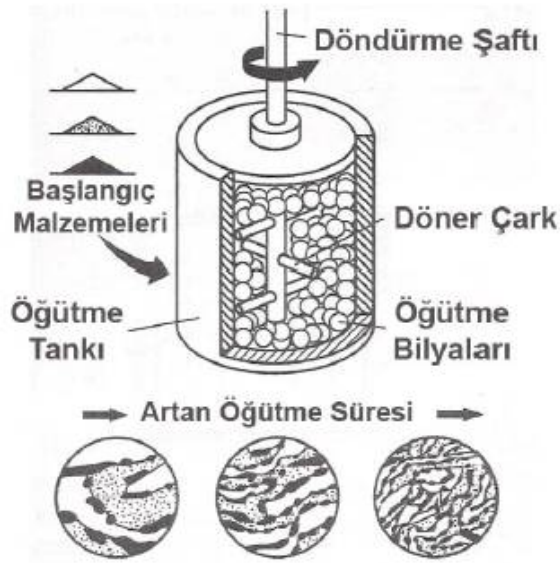
Şekil 4.4 : Mekanik alaşımlama prosesinde bilya toz etkileşimi ve morfoloji değişimi (Goff, 2003).
