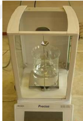
Şekil 5.17: Arşimet yoğunluk ölçüm düzeneği.
