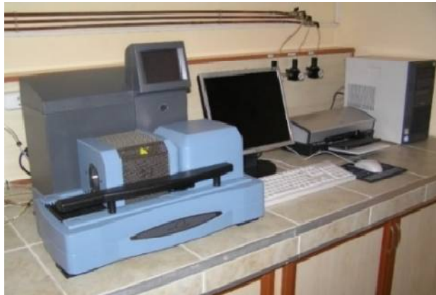
Şekil 5.10: TA Instruments™ DTA/DSC/TGA termal analiz cihazı.
