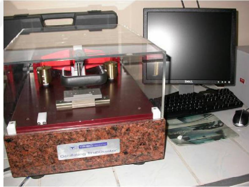
Şekil5.20: Tribotester TM Aşınma cihazı.
