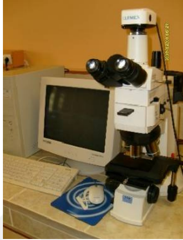
Şekil5.18: Nikon™ metal optik mikroskobu.
