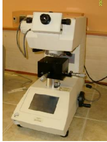
Şekil 5.19: Shimadzu TM mikrosertlik test cihazı.
