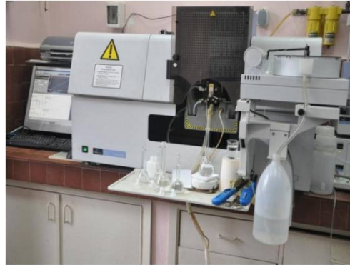
Şekli5.6: Perkin Elmer™ Analyst 800 atomik adsorpsiyon spektroskopisi.
