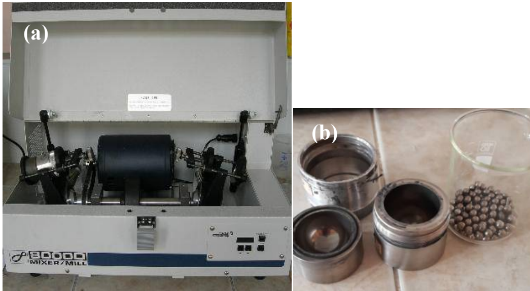
Şekil 5.2: a) Spex™ 8000D Dual Mixer-Mill Yüksek enerjili öğütücü b) Öğütücü kap ve bilyalar.
