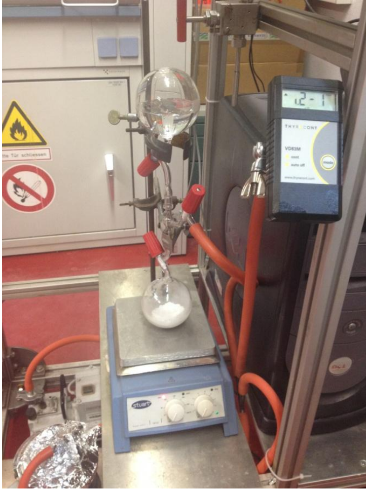
Resim 6.1. Kalsiyum asetat – su ikili karışımların hazırlanması sırasında kalsiyum asetat ve suyun vakum altında karıştırılması
