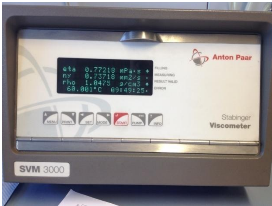
Resim 6.6. Viskozite ölçümlerinde kullanılmış olan için Anton Paar SVM 3000 Stabinger viskometre
