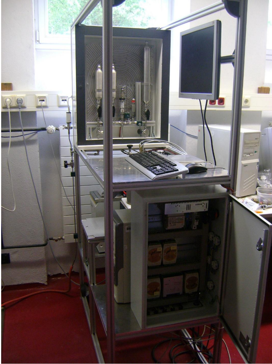
Resim 6.2. Kalsiyum asetatın farklı basınçlarda toplam karbon dioksit tutma kapasitelerinin belirlenmesinde kullanılan sistem
