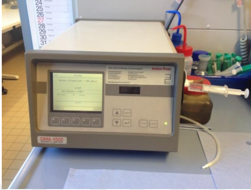
Resim 6.5. Yoğunluk ölçümlerinde kullanılmış olan için Anton Paar DMA 4500 salınımlı U tüp yoğunluk ölçer
