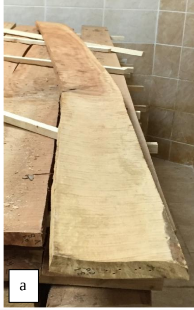
Şekil 4.19. Kılıcına eğilme (a), oluklaşma (b)
