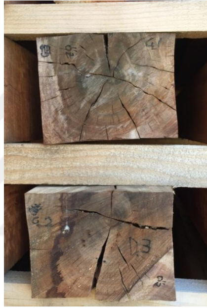
Şekil 4.18. Öz çatlağı meydana gelen bazı kereste örnekleri
