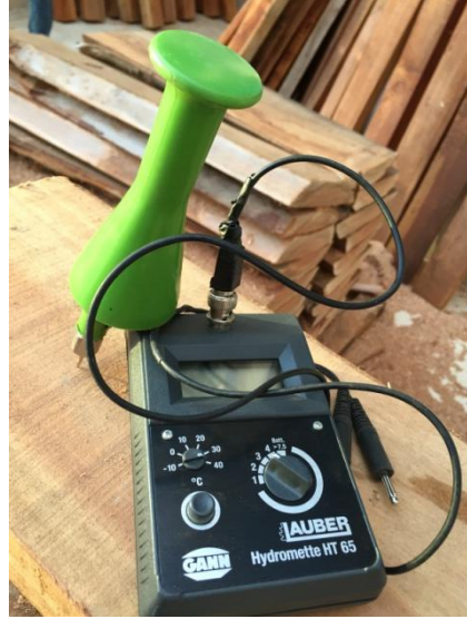
Şekil 3.7. Elektrikli rutubet ölçer
