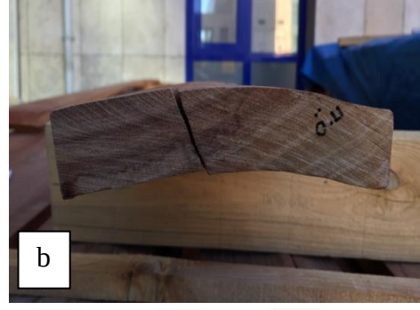
Şekil 4.19. Kılıcına eğilme (a), oluklaşma (b)
