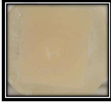
Şekil 44. Kırılma başarısızlık tiplerinden karışık kırılma örneği
