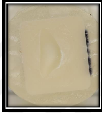
Şekil 43. Kırılma başarısızlık tiplerinden rezin içerikli seremiğin koheziv kırılma örneği
