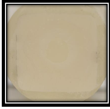
Şekil 42. Kırılma başarısızlık tiplerinden adeziv kırılma örneği
