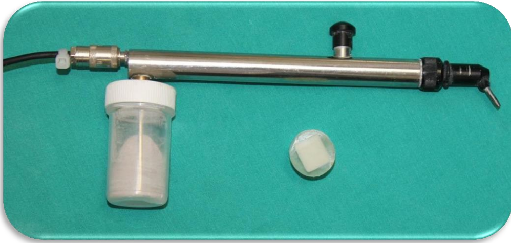
Şekil 15. Örnekleri kumlamada kullanılan ağız içi mini kumlama cihazı
