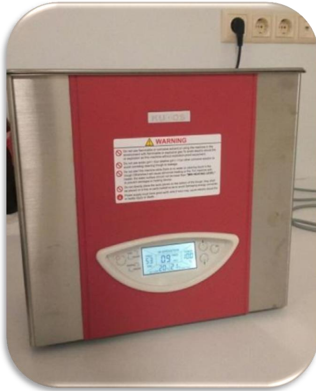
Şekil 9. Ultrasonik temizleyici ile yüzey temizliğinin sağlanması
