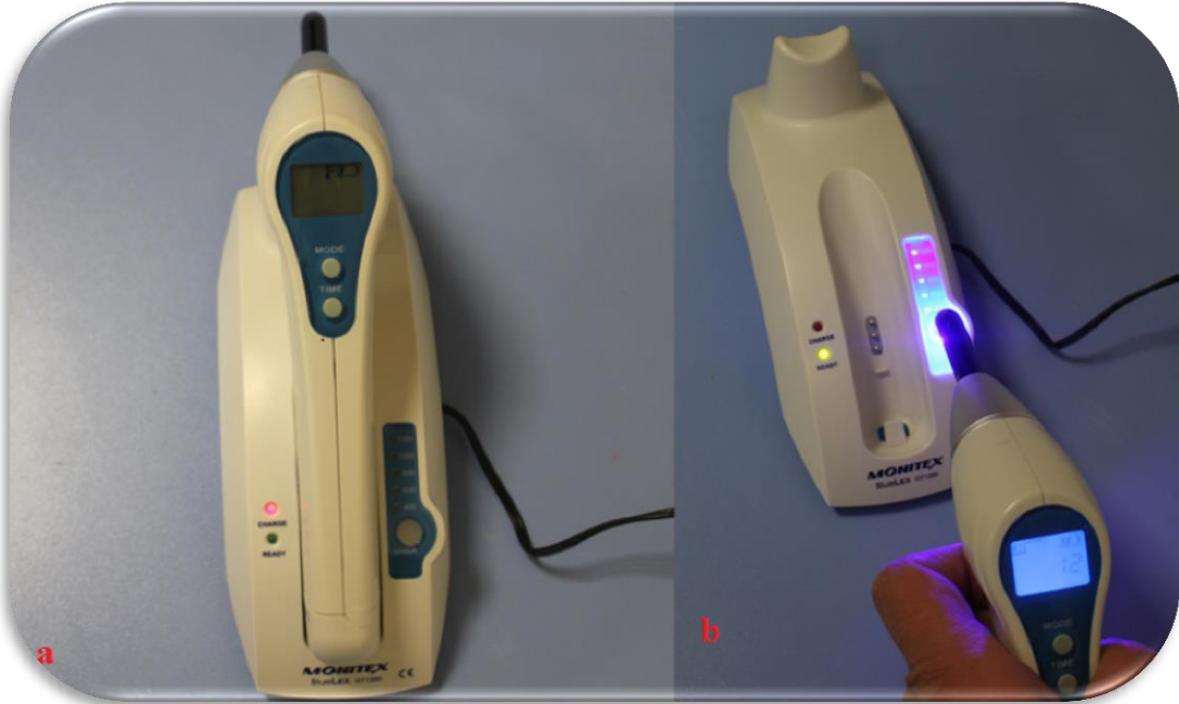
Şekil 21. a. Kompozit rezinlerin polimerizasyonunda kullanılan ışık cihazı b. cihazın radyometre ile ışık şiddetinin ölçülmesi
