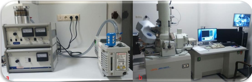
Şekil 18. a. Örneklerin Au-Pd kaplandığı Cihaz b. Taramalı Elektron Mikroskobu
