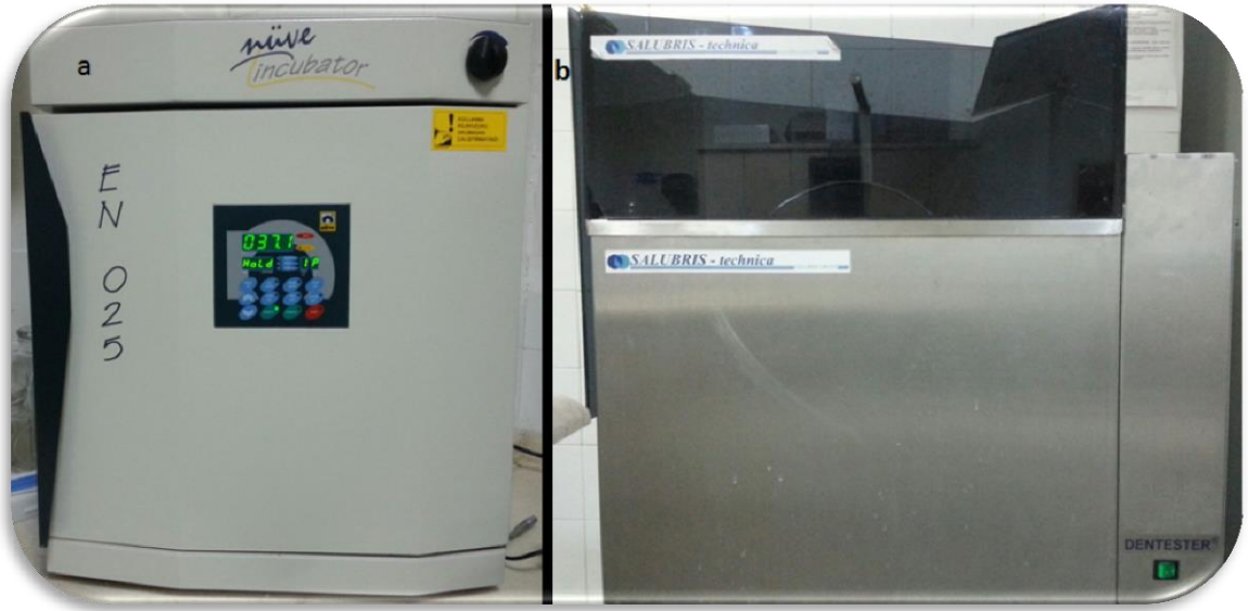
Şekil 22. Yapay yaşlandırmada kullanılan cihazlar: a. Inkübatör cihazı b. Termal devirlendirme cihazı
