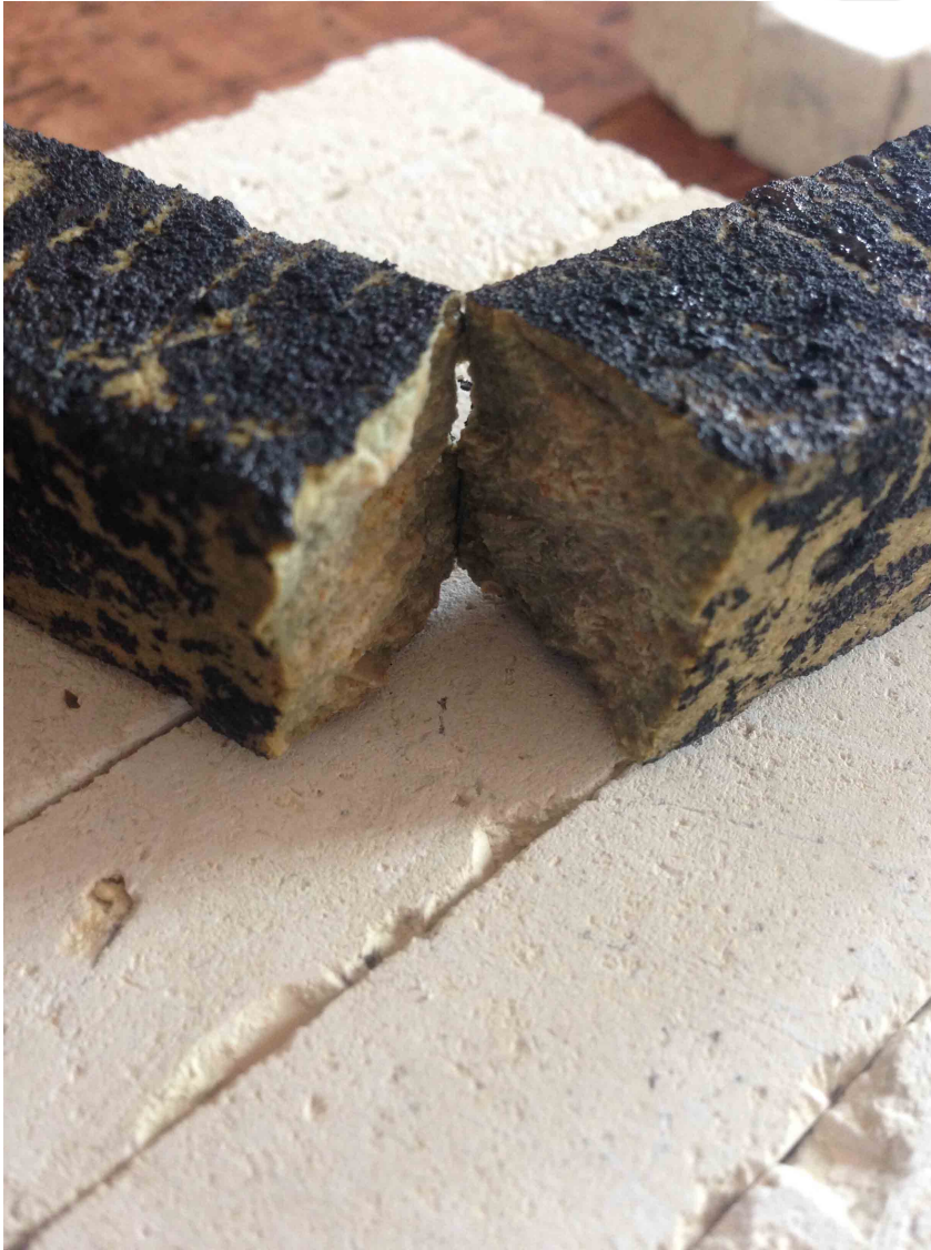
Şekil 5.3.13 : Epoksi reçine uygulaması sonucu iç yapısı zarar görmüş numuneler
