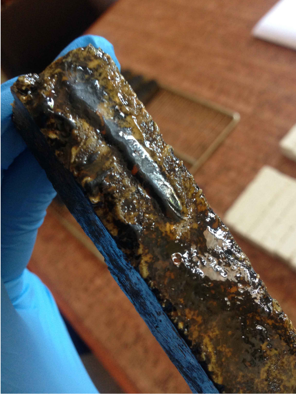
Şekil 5.3.12: Epoksi reçinenin CNT kombinasyonları ile birlikte uygulandığı numunedeki yüzey hasarları ve kabuklanmalar
