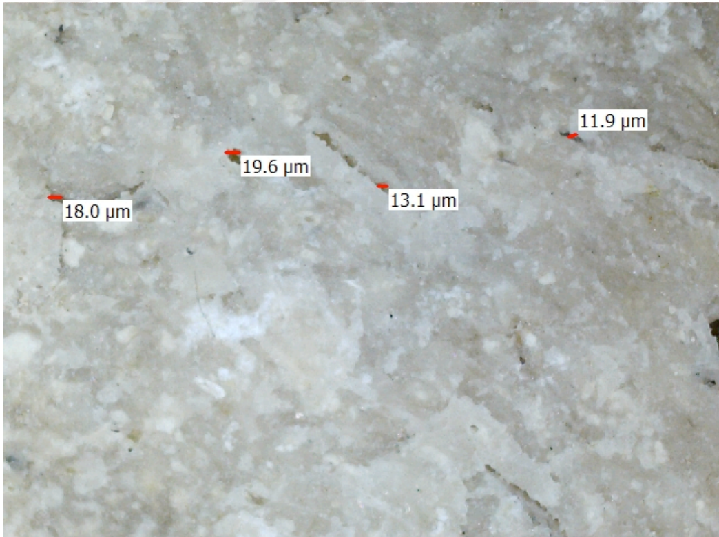
Şekil 5.30 : Avlu duvarından alınan 5 nolu numunenin hasar analizi ve penetrasyon boşlukları _ 5
