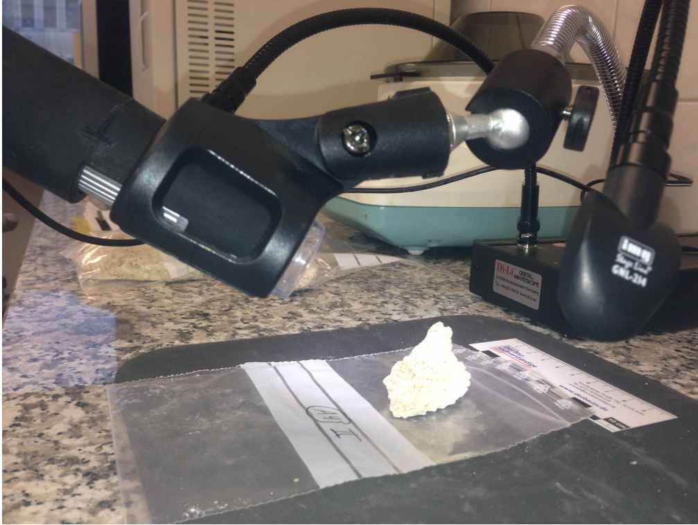
Şekil 5.25: Gözenek boyutu ve yapı içindeki kırık ve çatlakların nanoformülasyonlarla tedavisi öncesi tespit çalışmaları – Almanya Dresden Prof Dr Gerald Ziegenbalg Laboratuvarları
