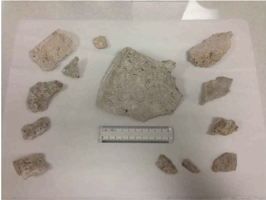
Şekil 5.10 : Temizleme işlemi öncesi Bayezid Camisi’nden alınan numunelerden örnekler
