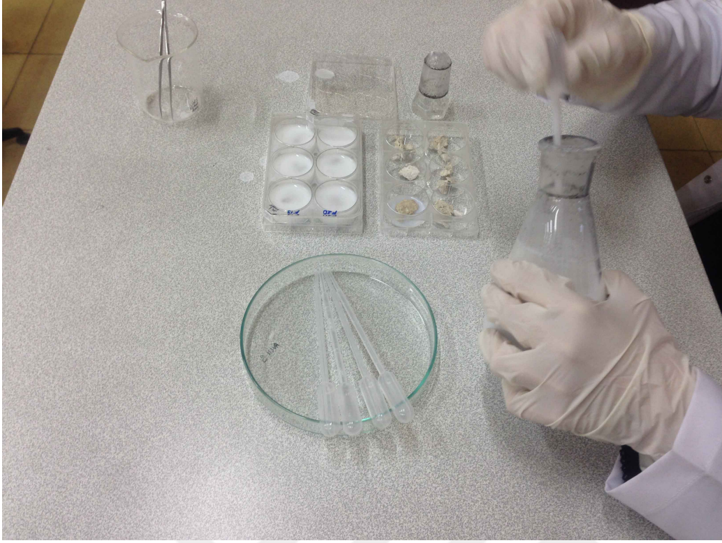
Şekil 5.3.2: Nanoformülasyonların kubbe ayağı numuneleri üzerine uygulanması
