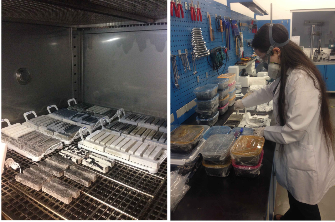
Şekil 5.3.5: İTÜ Tuzla Denizcilik Fakültesi’nde penetrasyon sonrası karbonatlaşma prosesi için numunelerin test kabinine alınması _2
