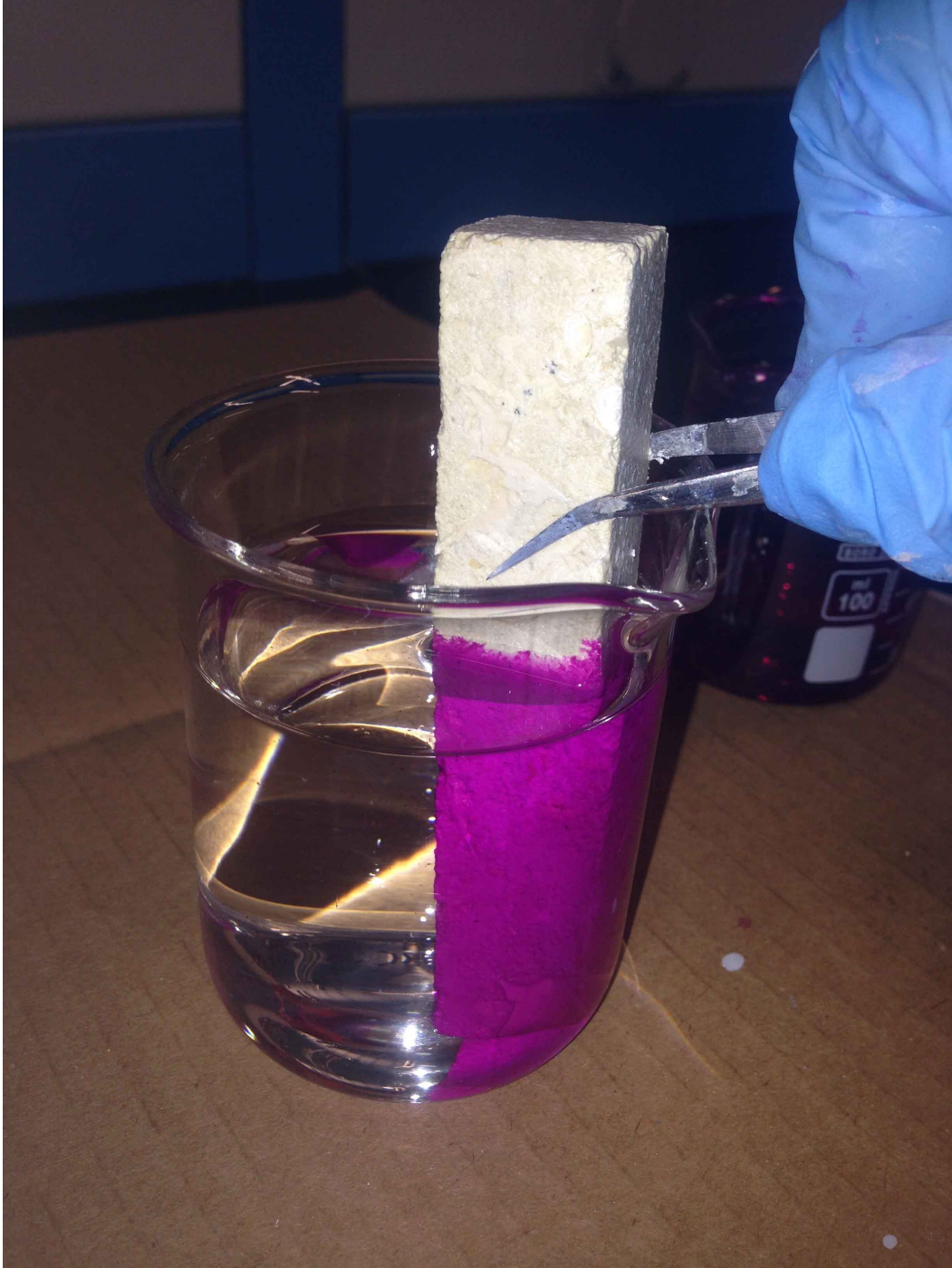
řekil 5.3.6: İTÜ Tuzla Denizcilik Faköltesi'nde penetrasyon sonrası karbonatlaşma prosesinin kontrolü için fenolftalein testi ile nanotedavinin deđerlendirilmesi_2
