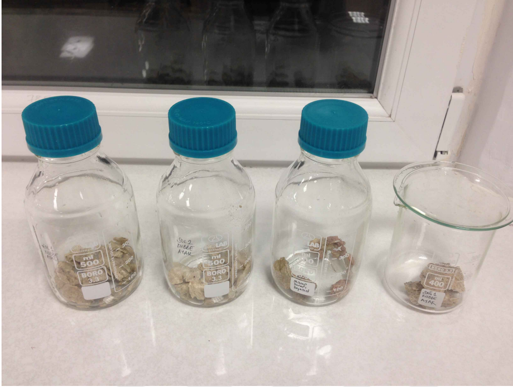
Şekil 5.19: Sağ 1, sol1, sol2 kubbe ayağı ve mihrap duvarı numuneleri temizleme sonrası görünümü
