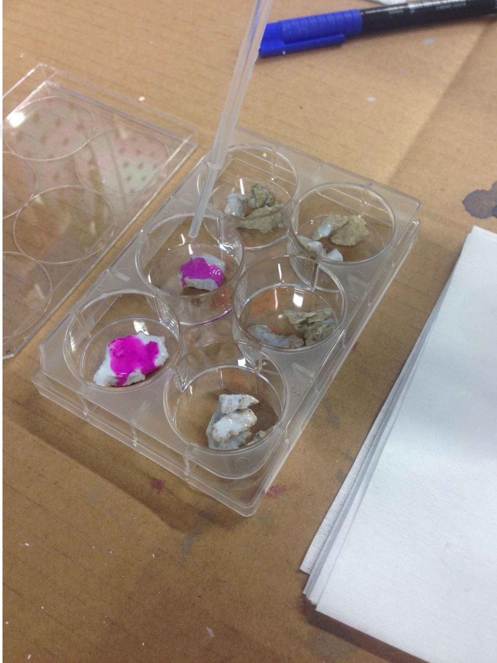
řekil 5.3.9: İT Tuzla Denizcilik Fakltesi'nde penetrasyon sonrası karbonatlařma prosesinin kontrol iin fenolftalein testi ile nanotedavinin deėerlendirilmesi_Bayezid Camisi numuneleri
