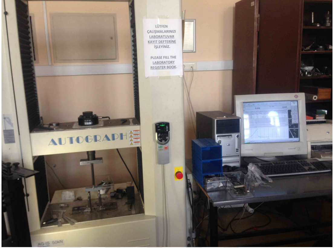
Şekil 5.3.14: İTÜ Gümüşsuyu Kampüsü Makina Mühendisliği Bölümü Mekanik Deneyler Laboratuvarı'nda yapılan 3 nokta eğilme mukavemeti testleri 140 numunenin her biri için tek tek çalışılmıştır. Testler tam gün çalışma ile yaklaşık 1 hafta sürmüştür.
