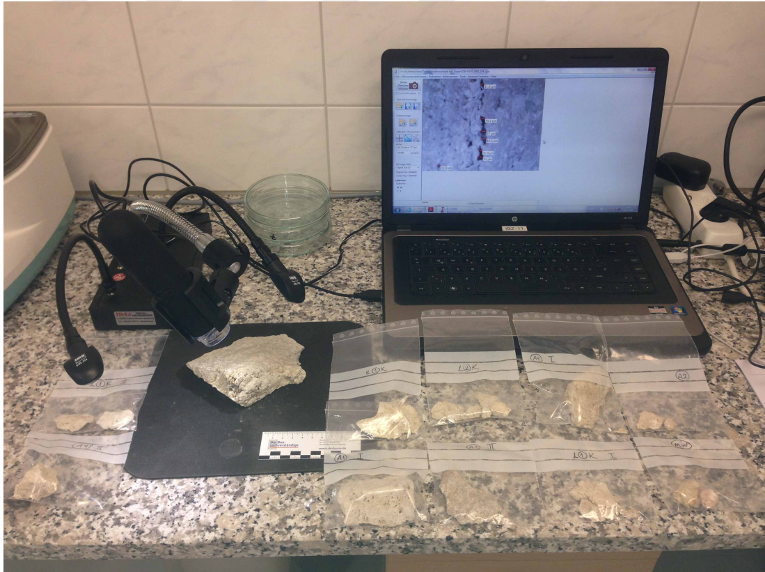
Şekil 5.23: Numuneler üzerinde gözeneklilik ve partikül boyutu analizi – Almanya Dresden – Prof Dr Gerald Ziegenbalg laboratuvarları
