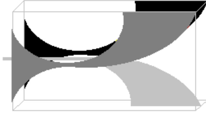
Şekil 2.13. Dengelenmiş zıt kutuplu Vivaldi anten geometrisi
