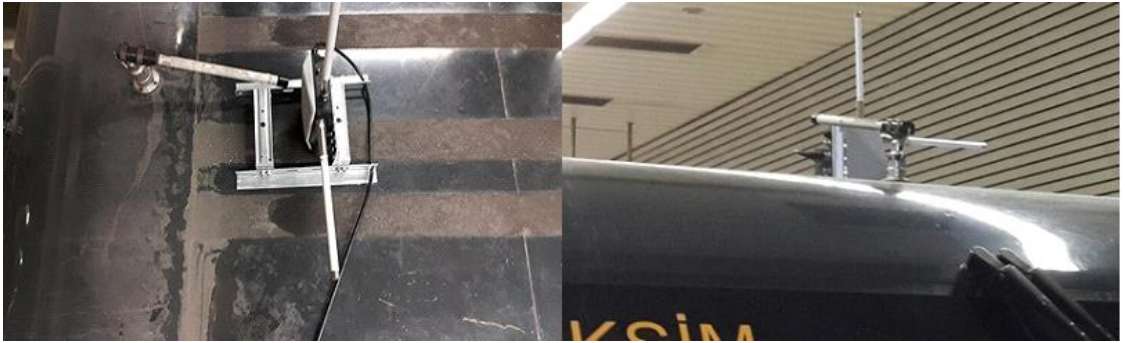
Şekil 4.24 Füniküler araç üstü erişim noktası cihazı
