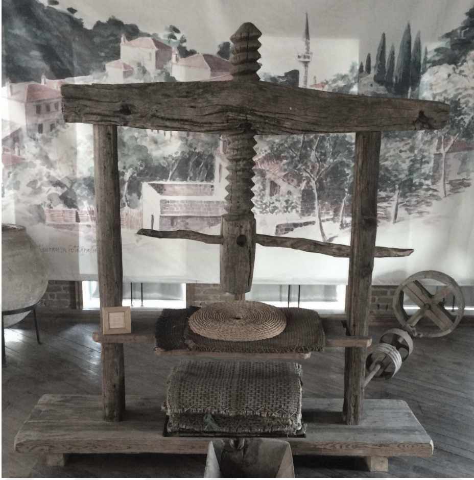
Resim III.12 Küçükkuşu'da bulunan ve türünün Türkiye'deki en önemli örneği olan Adatepe Zeytinyağı Müzesi'nde sergilenen bir ahşap vidalı mengene.
