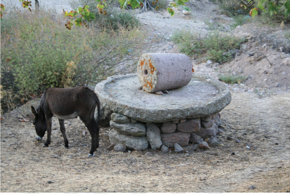
Resim III.7. Ayvacık İlçesine bağlı Koyunevi Köyü'nde bir zamanlar zeytin kırma aşamasında kullanılan dairesel pres yatağı ve üstündeki kesik koni biçimli ezgi taşı
