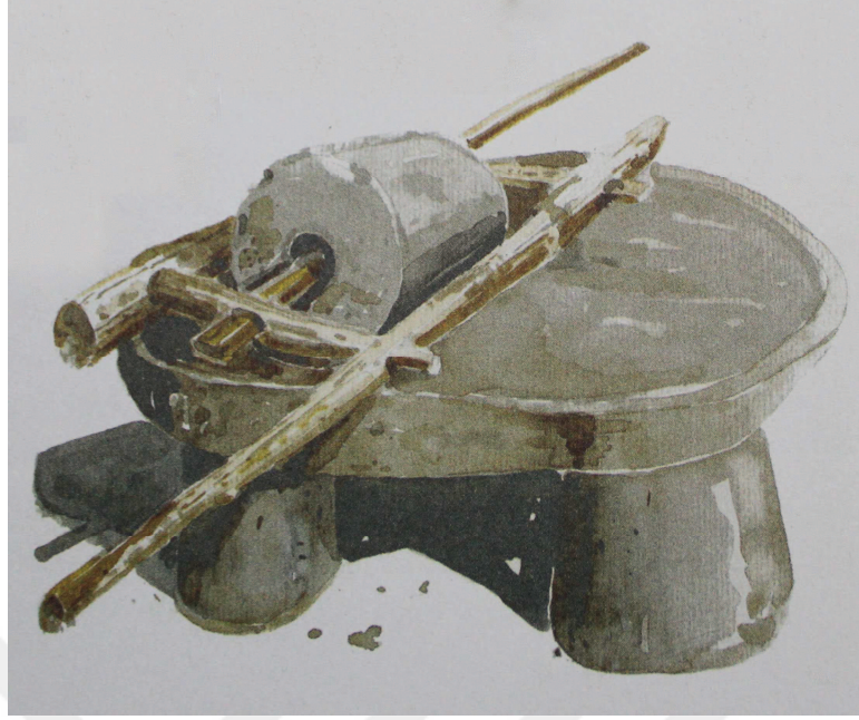
Resim III.5. Çanakkale yöresinde son elli yıl öncesine kadar sıklıkla zeytin meyvesini kırmada kullanılan dairesel hareketle çalışan tek kesik koni biçimli yatay silindir taş değirmen (Boynudelik ve Boynudelik 2008: 69)
