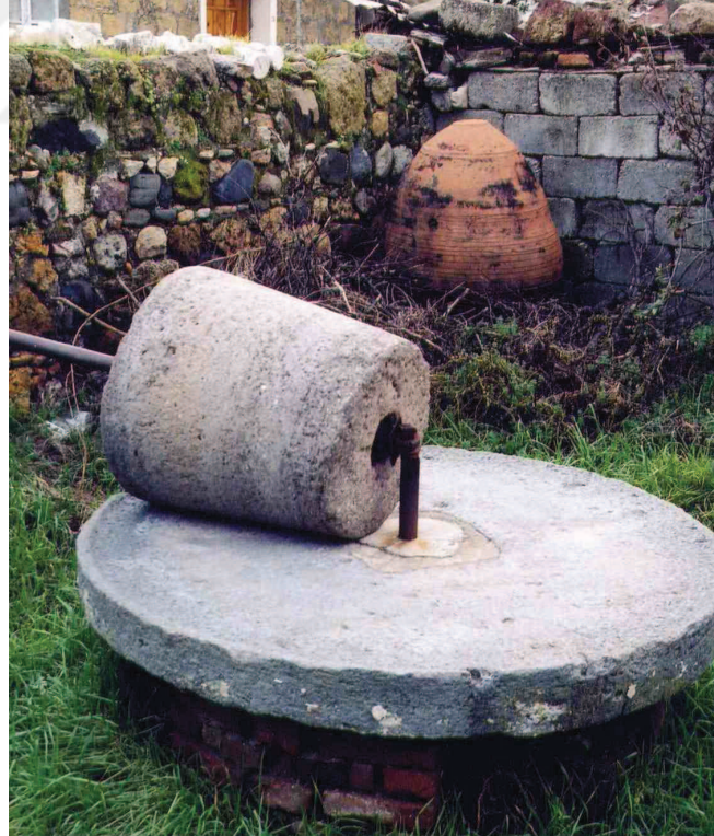
Resim III.8. Küçükkuyu sahilinde geç Osmanlı Döneminde yapılmış ve Erken Cumhuriyet döneminde kullanılmış ama şimdilerde terk edilmiş zeytinyağı fabrikası içinde zeytin kırma düzeneği ve arkada bir saklama küpü.
