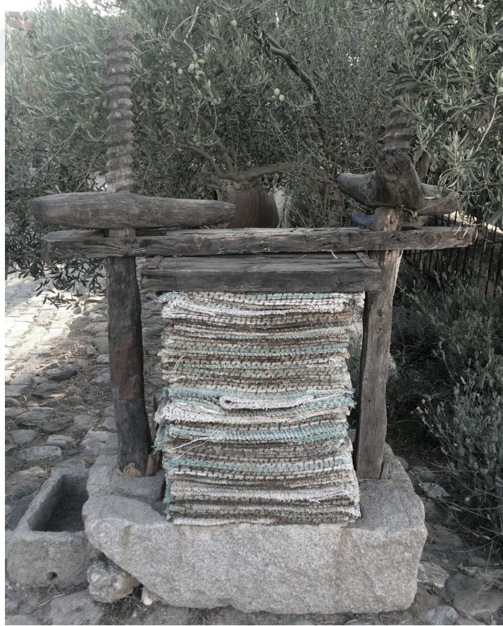
Resim III.13. Küçükkuyu’da bulunan iki vidalı ahşap vidalı mengene örneği.
