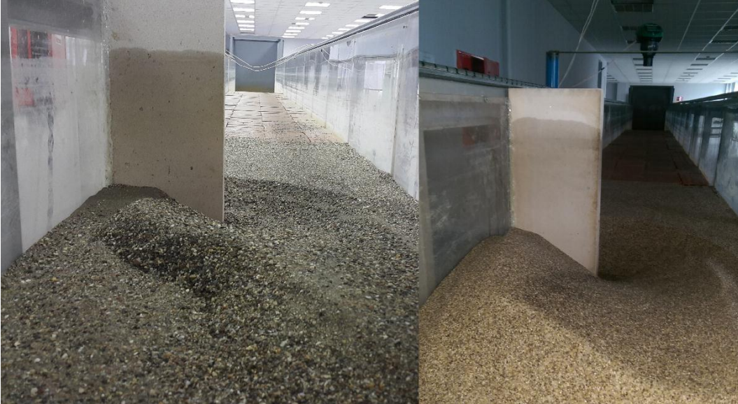
Şekil 3.23. b=25 cm uzunluklu 90^\circ açılı mahmuzla 30 l/s lik debide üniform (sağda) ve üniform olmayan taban malzemeleriyle yapılan deneyler
