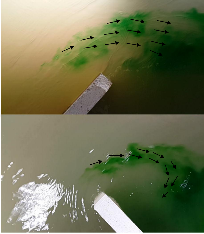
Şekil 3.25. 135° (üstte) ve 45° açılarda 45 l/s 'lik deneylerdeki türbülans durumu
