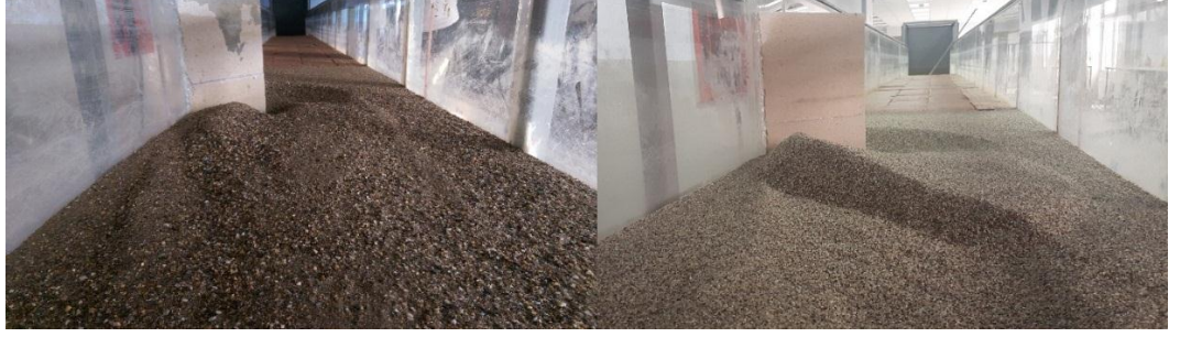
Şekil 3.24. b=20 cm uzunluklu 45^\circ açılı mahmuzla 30 l/s lik debide üniform (sağda) ve üniform olmayan taban malzemeleriyle yapılan deneyler
