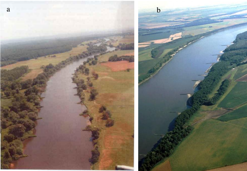
Şekil 1.2. Çift yönlü ve tek yönlü mahmuz uygulamaları a) Odra Nehri (Polonya) b) Missisipi nehri (ABD)
