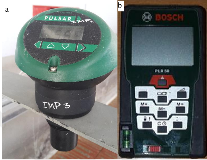
Şekil 3. 7. a- Ultrasonik seviye ölçer b Dijital lazer metre
