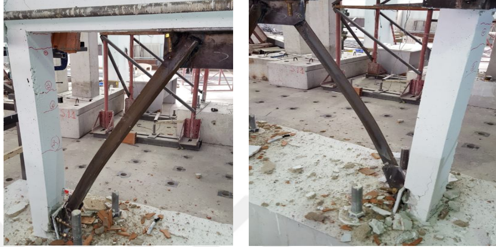
Şekil 4.35. Deney sırasında merkezi ters V çelik çapraz çerçeve numunesine (DN4-VÇAP) ait çelik profillerde görülen burkulma ve plakalardaki ankraj bulonları sıyrılma.
