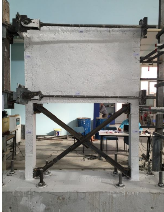
Şekil 4.19. Merkezi X çelik çaprazla güçlendirilmiş çerçeve numunesinin (DN3-XÇAP) deney öncesi görünümü.
