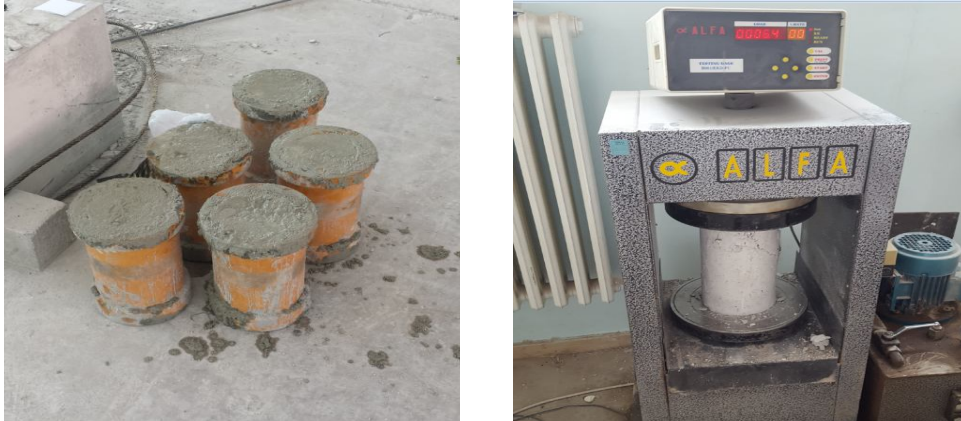
Şekil 3.5. Beton basınç dayanımlarının belirlenmesi.
