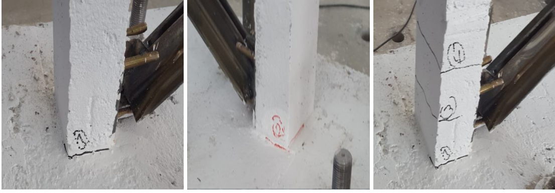
Şekil 4.22. Merkezi X çelik çapraz çerçeve numunesine (DN3-XÇAP) ait ilk çatlaklar.
