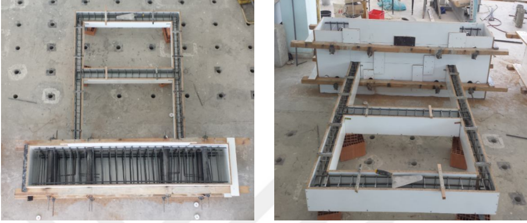
Şekil 3.3. Çerçeve numunelerin beton dökümünden önceki görünümü.
