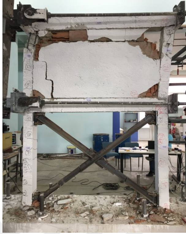
Şekil 4.23. Merkezi X çelik çapraz çerçeve numunesinin (DN3-XÇAP) deneyden sonraki görünüşü.
