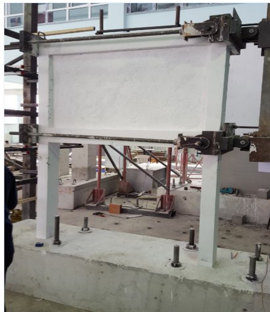
Şekil 3.13. Deneyden önce üst katı dolgu duvarlı çerçeve numunenin (DN2-YKÇ) durumu.
