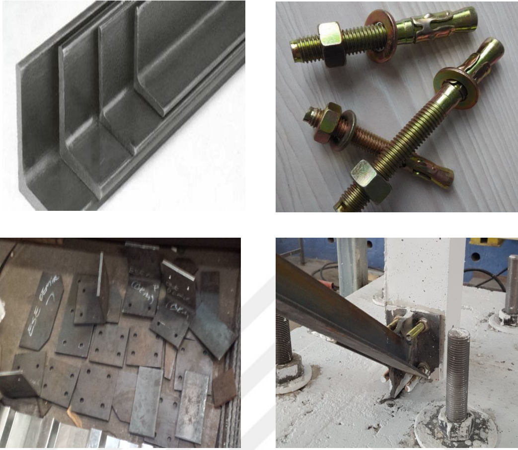
Şekil 3.15. Çelik çaprazlı numunelerde kullanılan malzeme ve detaylar.
