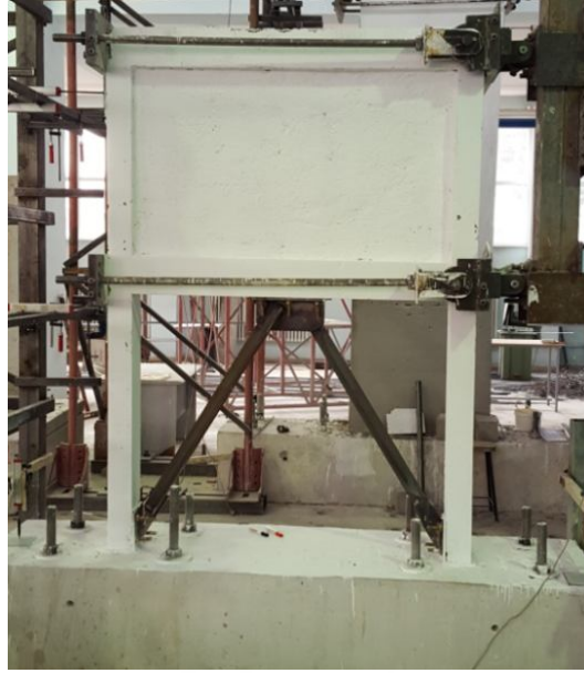
Şekil 3.19. Deneyden önce merkezi ters V çelik çaprazlı numunenin durumu.
