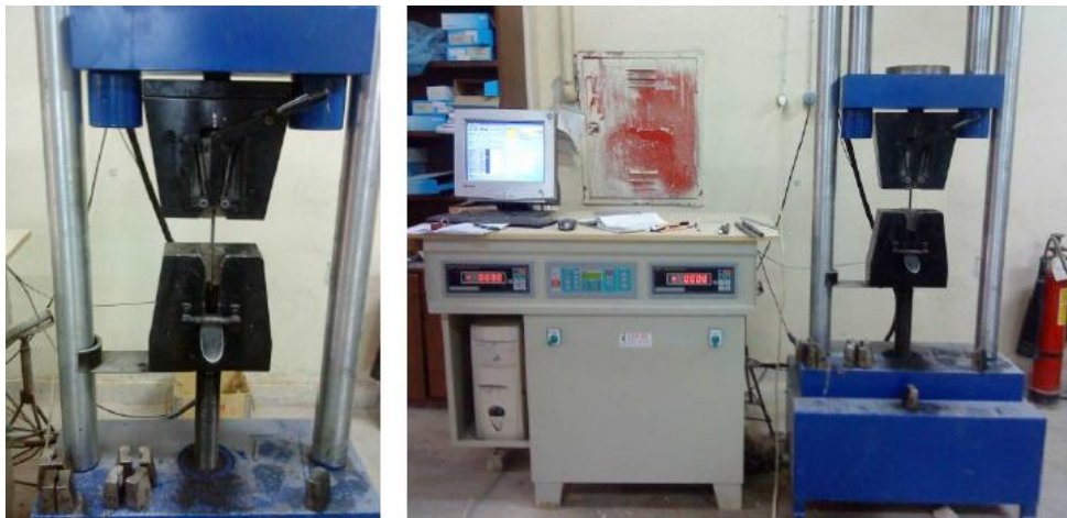
Şekil 3.6. Örnek bir donatı çeliği çekme deneyi.
