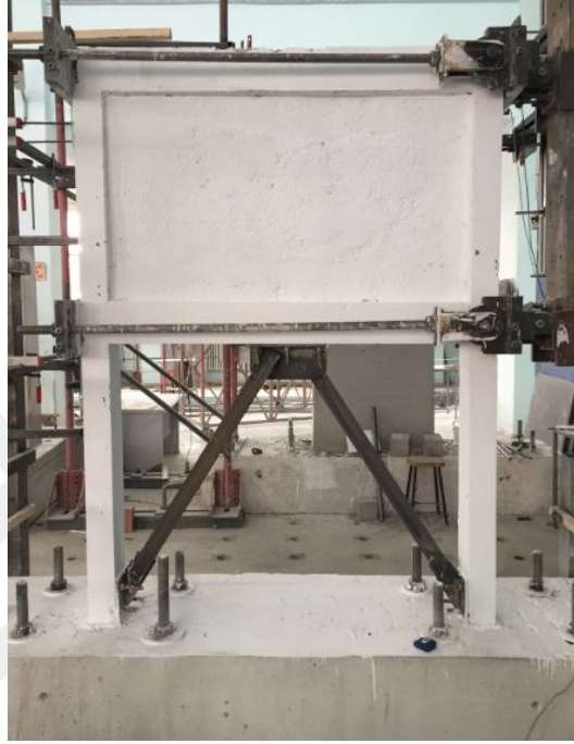
Şekil 4.28. Merkezi V çelik çapraz çerçeve numunesinin (DN4-VÇAP) deney öncesi görünümü.
