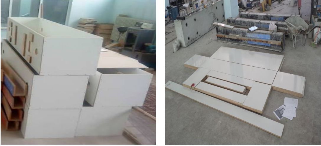
Şekil 3.7. Deney numuneleri kalıplarının hazırlanması.
