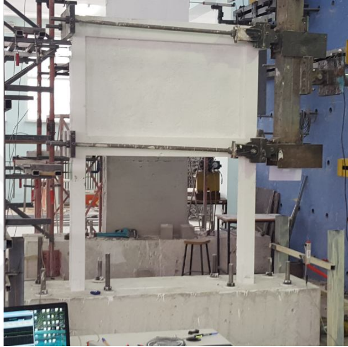
Şekil 4.10. Yumuşak katlı çerçeve numunesinin (DN2-YKÇ) deney öncesi görünümü.
