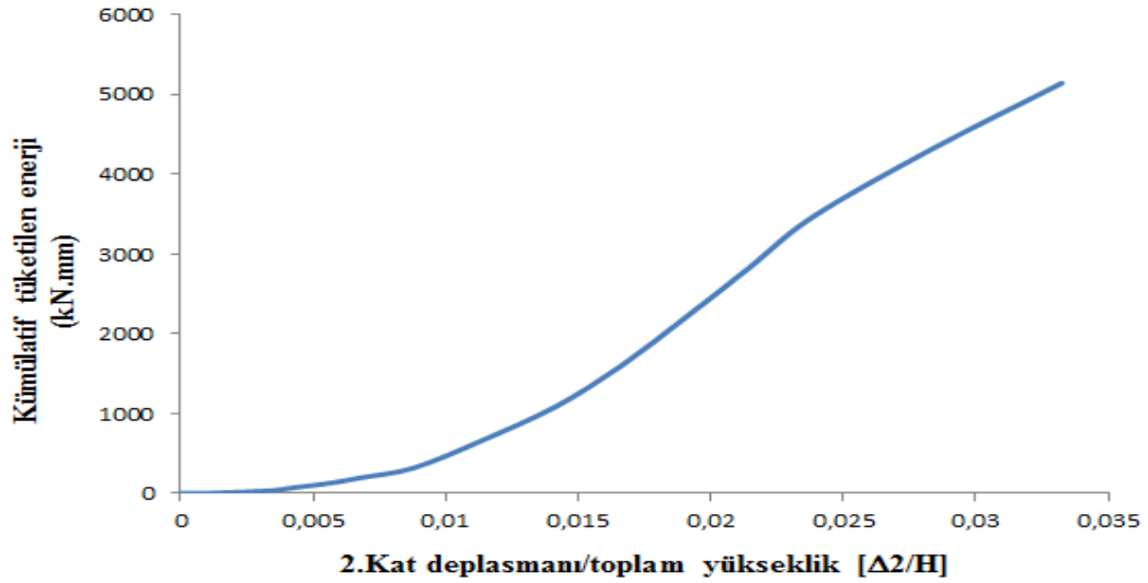
Şekil 4.18. Yumuşak katlı çerçeve numunesine (DN2-YKÇ) ait kümülatif toplam tüketilen enerji – 2. kat ötelenme oranı grafiği.
