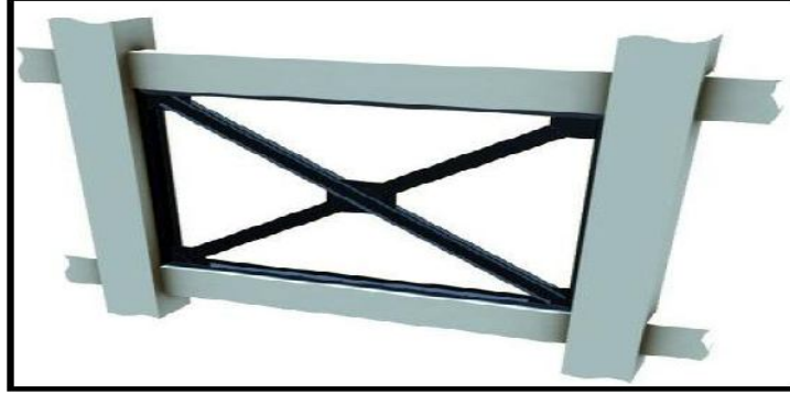
Şekil 1.16. Çerçeve açıklığının çelik çapraz elemanlarla güçlendirilmesi (Şik, 2014).
