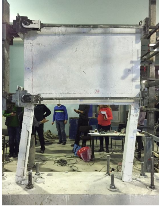
Şekil 4.14. Yumuşak katlı çerçeve numunesinin (DN2-YKÇ) deneyden sonraki görünüşü.
