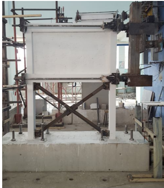
Şekil 3.16. Deney öncesinde merkezi X çelik çaprazlı numunenin (DN3-XÇAP) durumu.
