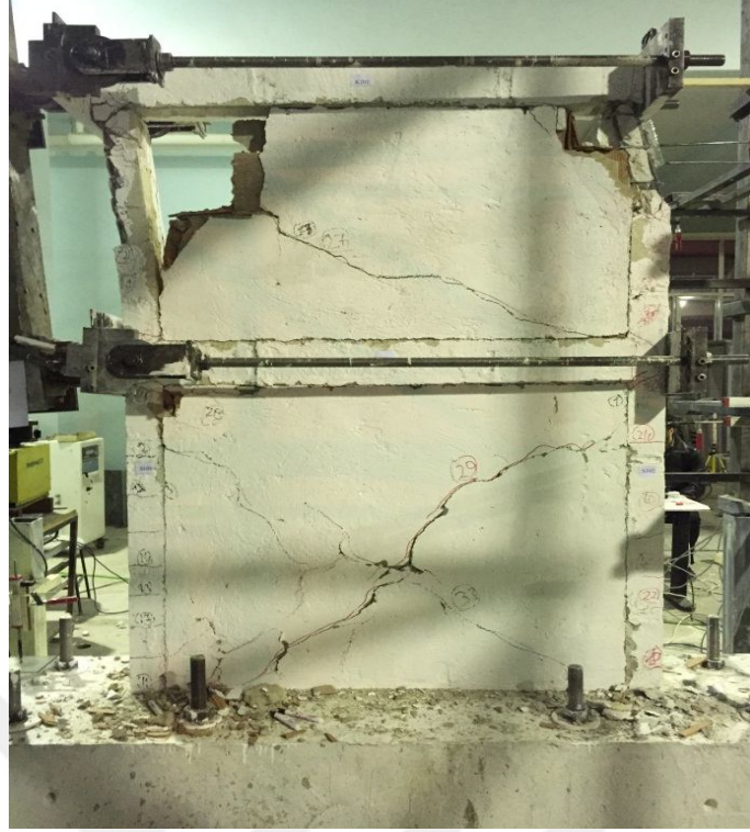
Şekil 4.6. Referans çerçeve numunesinin (DN1-RÇ) deneyden sonraki görünüşü.
