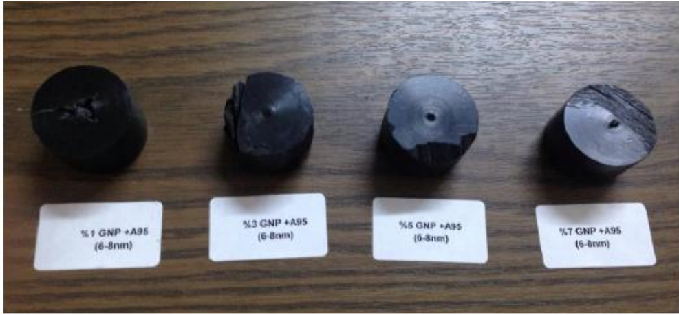
Şekil 2. A95 FDM içerisine kütlece %1-%7 bölüntü oranlarında katkılanan 10-20 nm KNT ve Grafen kompozitlerin katkılandıktan sonraki durumları.
