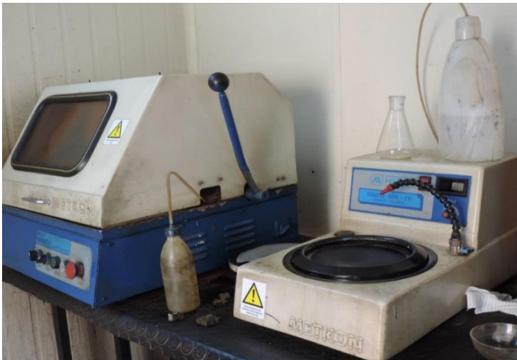
Resim 9.4. Kesme, zımparalama ve parlatma makineleri
