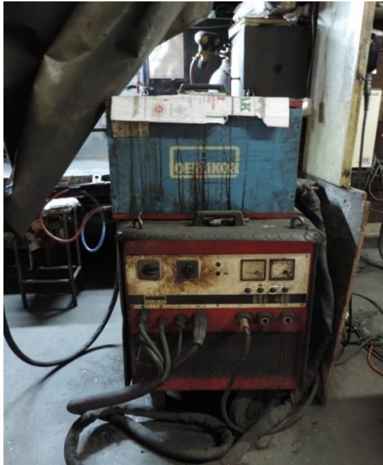
Resim 9.2. Deneyde kullanılan gazaltı kaynak makinesi
