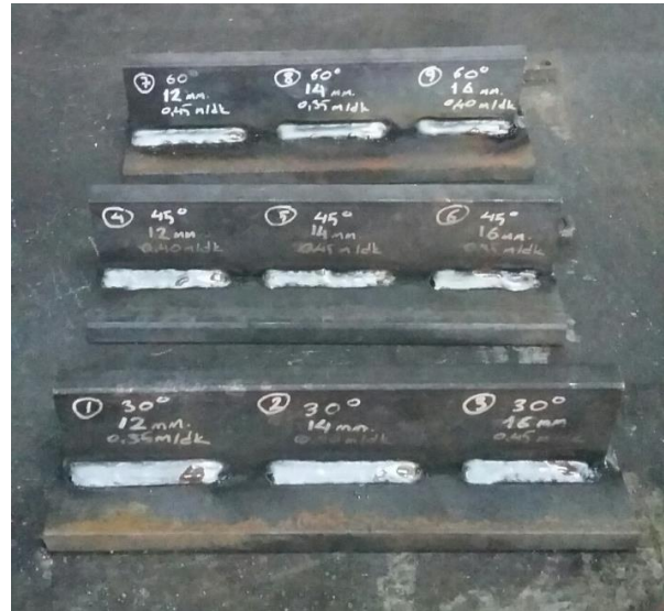
Resim 8.7. Deney tasarımı numuneleri
