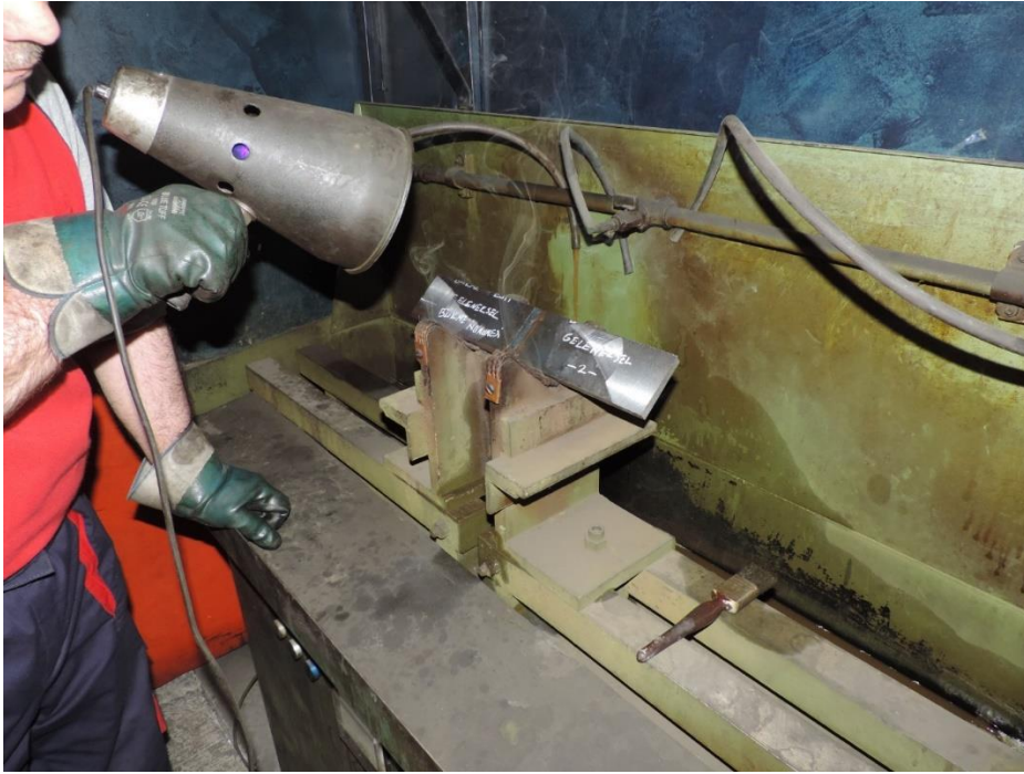
Resim 10.1. Penetrant sıvı ile çatlak kontrol tezgahı
