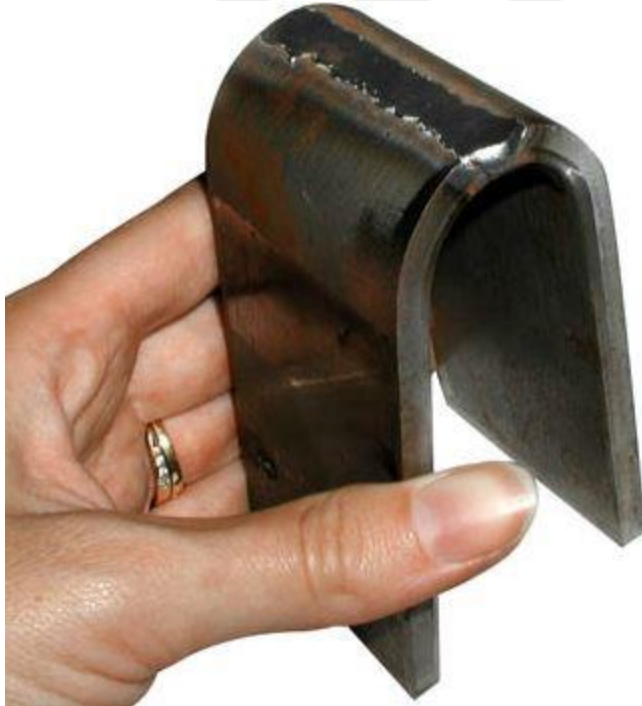
Resim 5.5. Bükme testi uygulanmış parça
