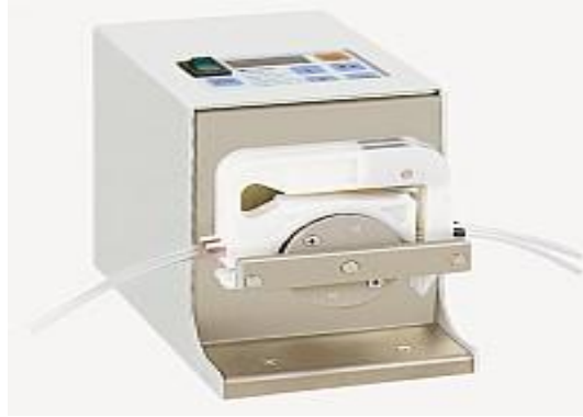
Şekil 2.10.3. Kuartz kristale sürekli akış sağlayan mikro pompa resmi.
