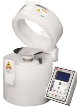
Şekil 2.4. Tez çalışmasında kullanılan döndürerek kaplama cihazı (Laurell).
