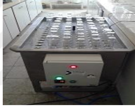
Şekil 3.6. su banyosunda enjektörlerin görünümü
