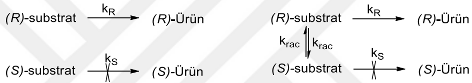
Şekil 1.17. Dinamik kinetik ayırımın şematik gösterimi
