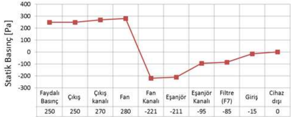
Şekil 5. 5 Taze hava fanı seçim girdileri ve yol-basınç düşümü grafiği
