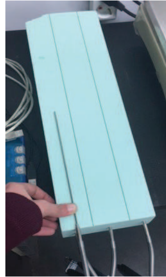
Şekil 4.6. Termal çiftlerin deney numunesine yerleştirilmesi
