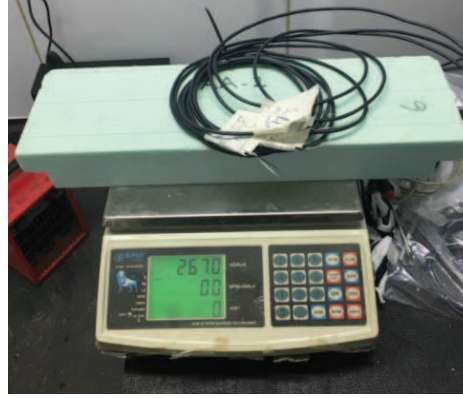
Şekil 4.2. Gravimetrik yöntem ile nem miktarı ölçümü
