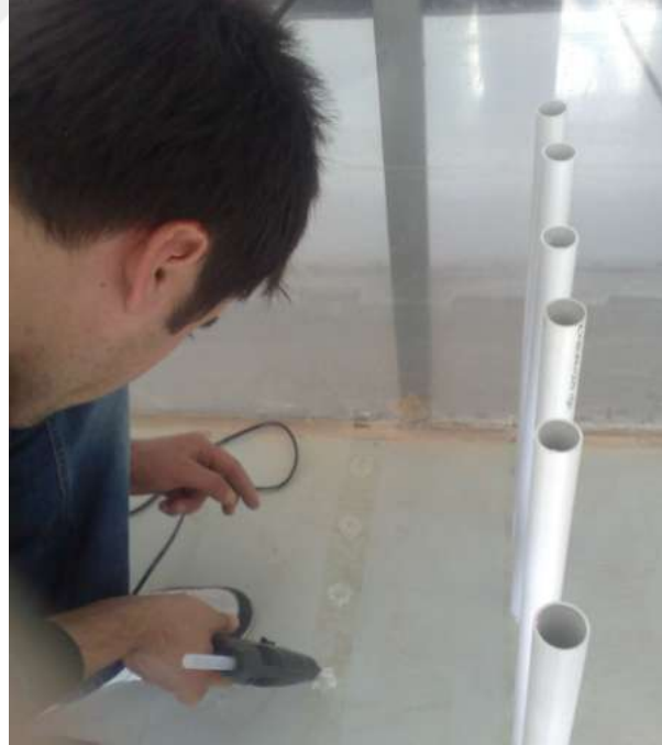
Şekil 2.9. Yapay pürüzlülük elemanlarının kanal tabanına yapıştırılışı
