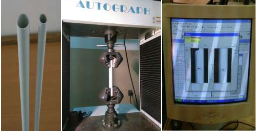
Şekil 2.8. Yapay pürüzlülük elemanları ve çekme deneyi görüntüleri
