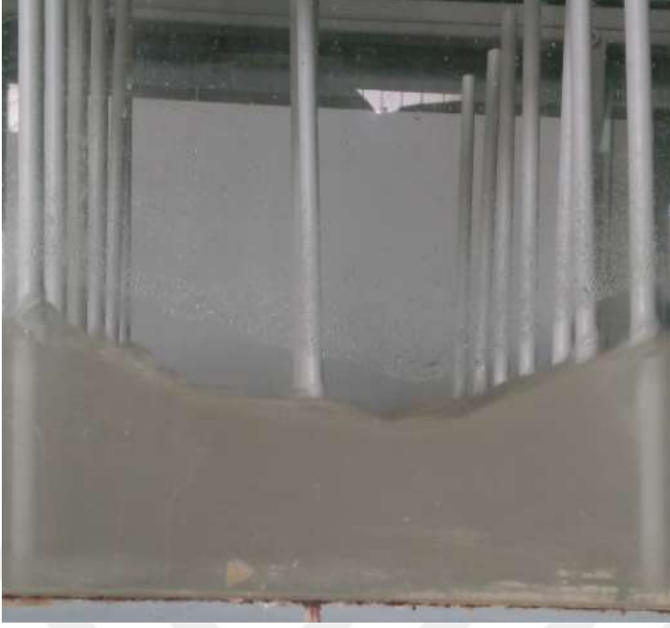
Şekil 2.16. Pürüzlülük elemanlarının kanal tabanına homojen dağılmadığı durum
