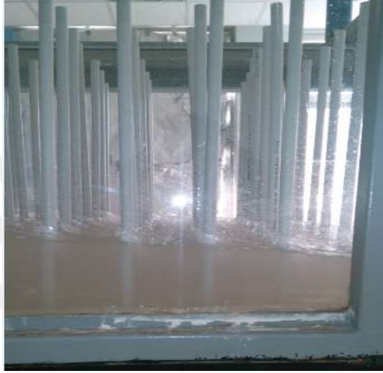
Şekil 2.15. Pürüzlülük elemanlarının kanal tabanına homojen dağıldığı durum
