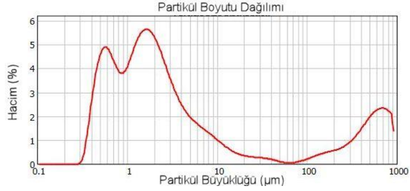
Şekil 31 JX membranından çıkan atıksuyun partikül boyutu analizi.
