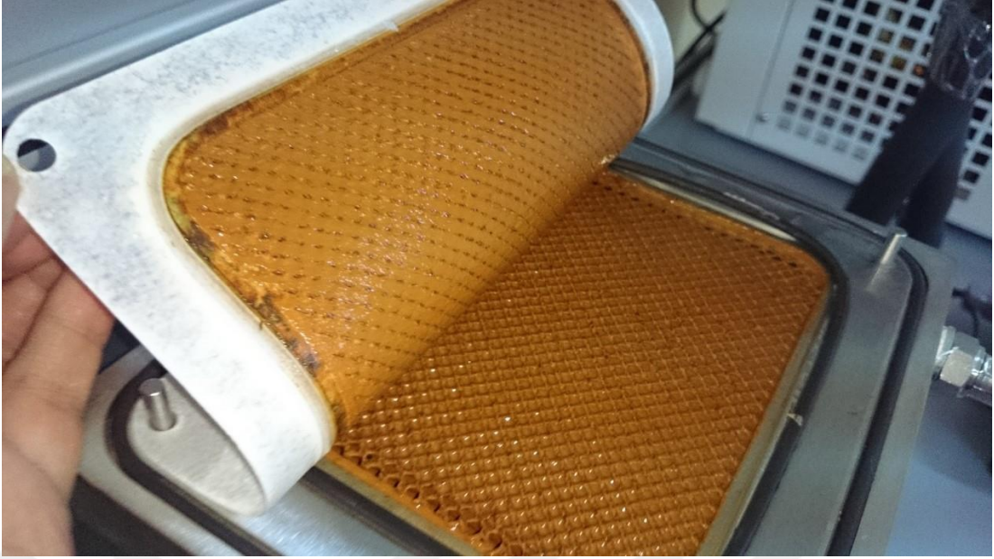
Şekil 20 \text{FeCl}_2 \cdot 4\text{H}_2\text{O} koagülantının membran üzerinde oluşturduğu tortu.
