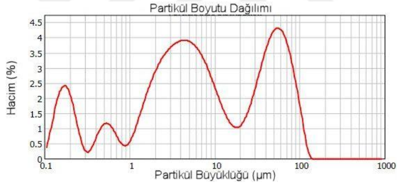
Şekil 32 TM10 membranından çıkan atıksuyun partikül boyutu analizi.
