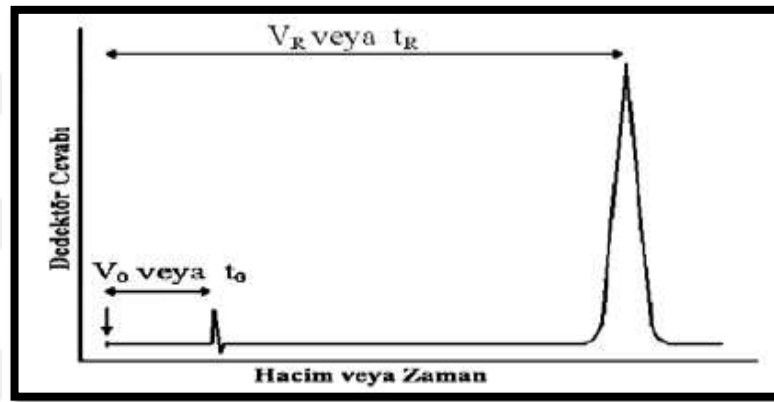
Şekil 2.5. Kapasite faktörü için kromatogram
