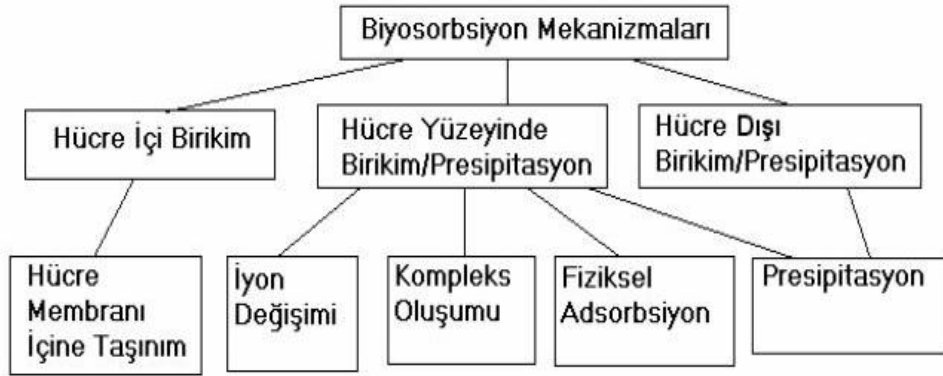
Şekil 2.1. Biyosorpsiyon mekanizmaları (a) Hücre metabolizmasına bağlı olup olmadıklarına göre
