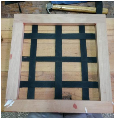
Resim 4.6. 75 mm aralıklarla bağlanan lastik kolanlı döşeme örneği
