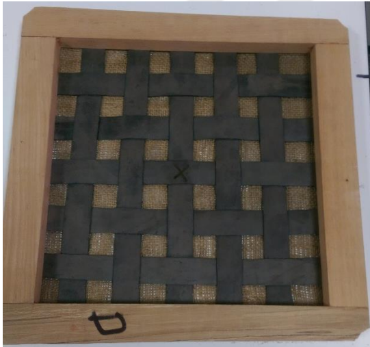
Resim 1.6. 25mm aralıkla bağlanan astarlı lastik kolanlı döşemede deney sonu
