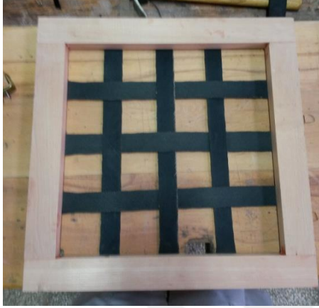
Resim 4.5. 50 mm aralıklarla bağlanan lastik kolan döşeme örneği
