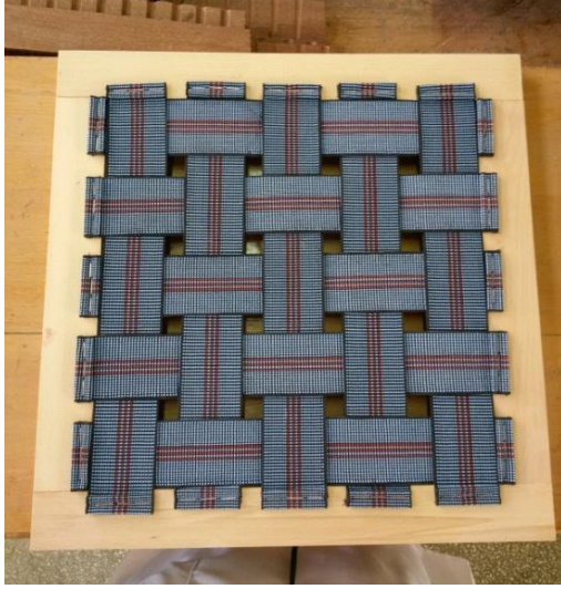
Resim 4.2. 25 mm aralıklarla bağlanan elastik kolan döşeme örneği
