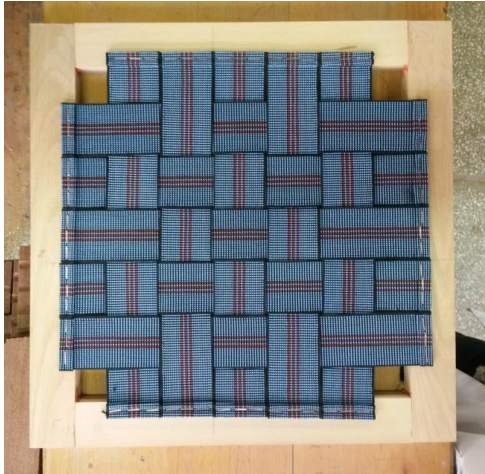
Resim 4.1. Boşluksuz bağlanan elastik kolan döşeme örneği
