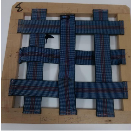
Resim 1.2. 50 mm aralıkla bağlanan elastik kolanlı döşemede deney sonu
