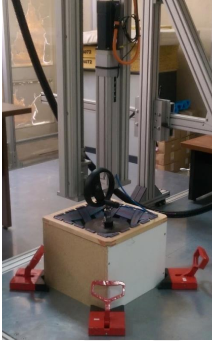
Resim 4.7. Servo motorlu mobilya performans test cihazı ve düzeneği
