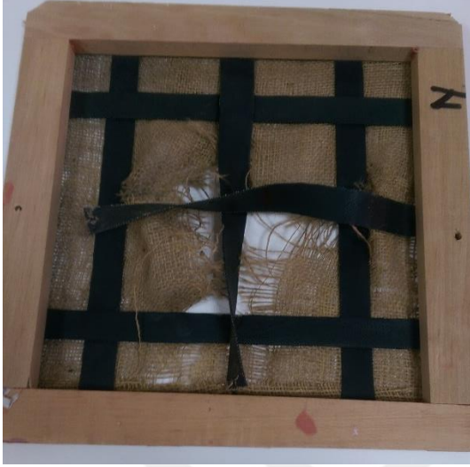
Resim 1.3. 75mm aralıkla bağlanan astarlı lastik kolanlı döşemede deney sonu
