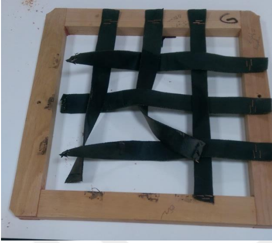
Resim 1.1. 50 mm aralıklı bağlanan lastik kolanlı döşemede deney sonu
