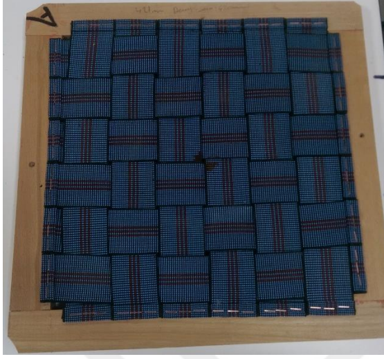
Resim 1.7. Boşluksuz bağlanan elastik kolanlı döşemede deney sonu
