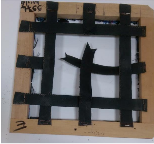
Resim 1.4. 75 mm aralıkla bağlanan lastik kolanlı döşemede deney sonu
