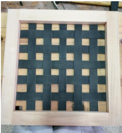
Resim 4.4. 25 mm aralıklarla bağlanan lastik kolan döşeme örneği
