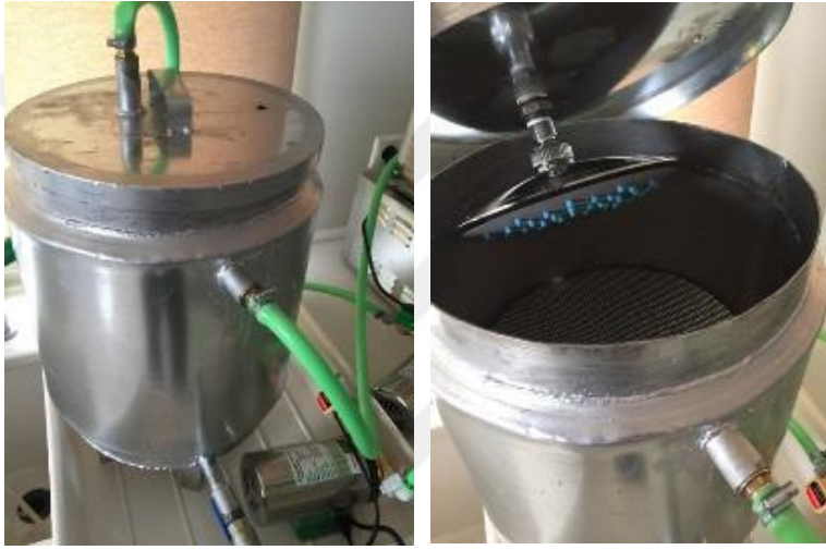
Şekil 3.8. Ozmotik kurutma işlemi için yaptırılan ceketli sistem
