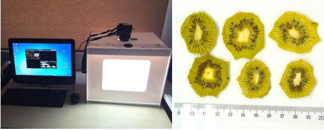
Şekil 3.9. Ürünlerin renk analizi için görüntülendiği sistem
