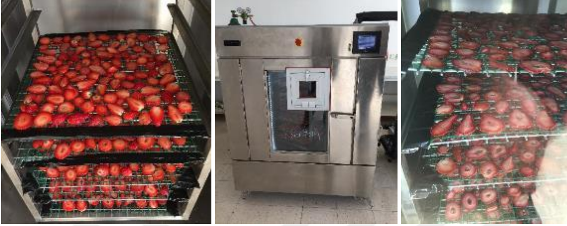
Şekil 3.7. Çileklerin kurutulması işlemi
