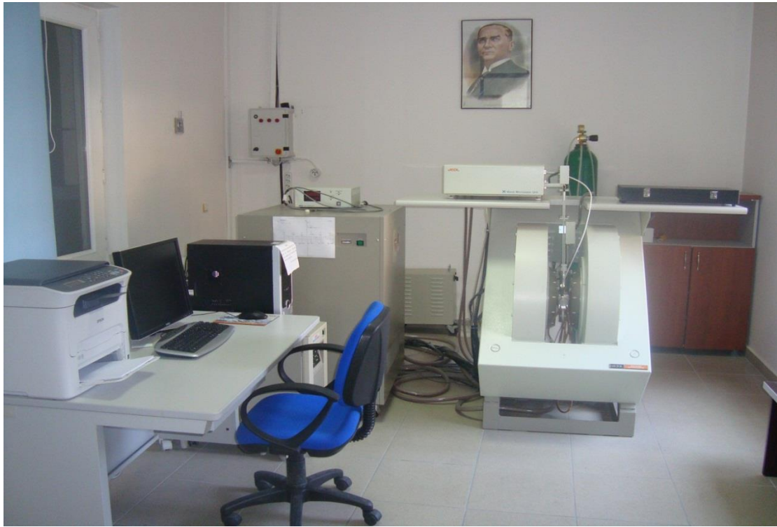
Şekil 3.3: Tarihlendirme için kullanılan JEOL JESFA-300 X-band ESR spektrometresi
