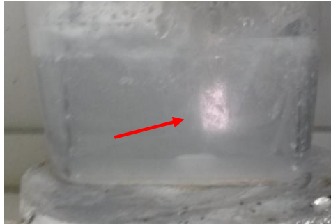
Şekil 6.18 Anotlama esnasında titanyum yüzeyinde spark oluşumu
