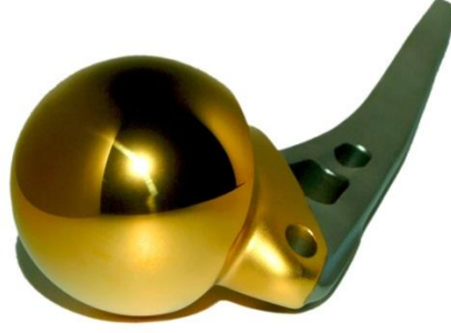
Şekil 3.6 PVD tekniği ile kaplanan implant yüzeyi
