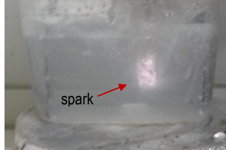
Şekil 7.4 Anotlama esnasında titanyum yüzeyinde spark oluşumu
