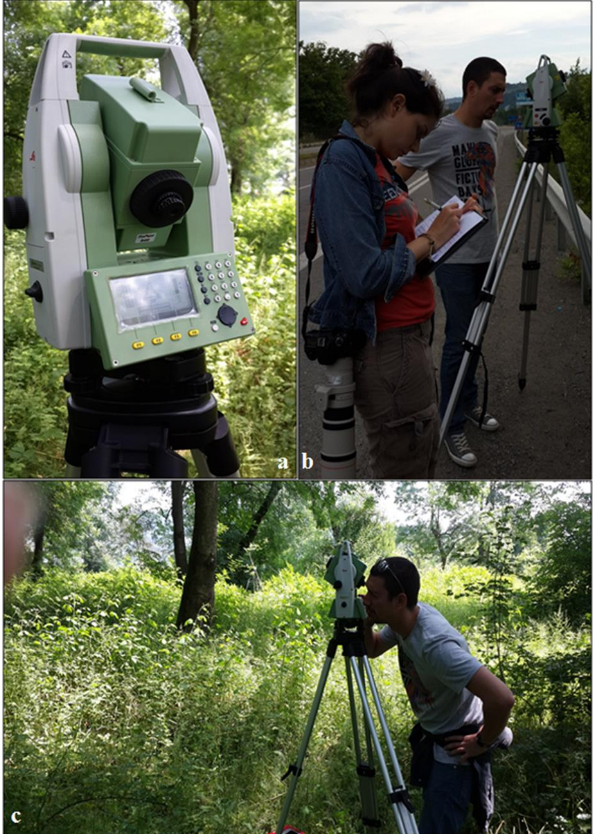
Şekil 2.6 Total Station ile gerçekleştirilen yuva ölçümleri (Foto: a) ve c) Merve Ünal, b) Recep Aydın).
