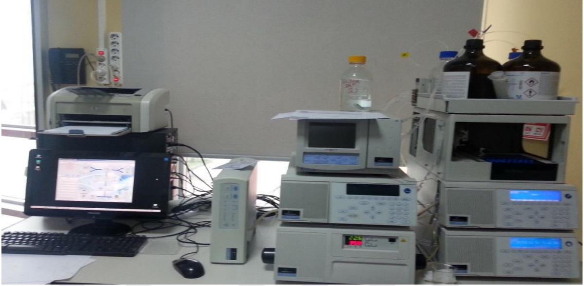
Şekil 3.5. Çalışmada kullanılan yüksek basınçlı sıvı kromatografi cihazı
