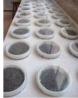
Şekil 3.6. Örneklerin su içerisinde 48 saat bekletilmesi
