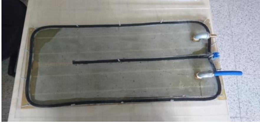
Şekil 5.1 Güneş paneli arkasına kurulan soğutma (kuler) sistemi düzeneği
