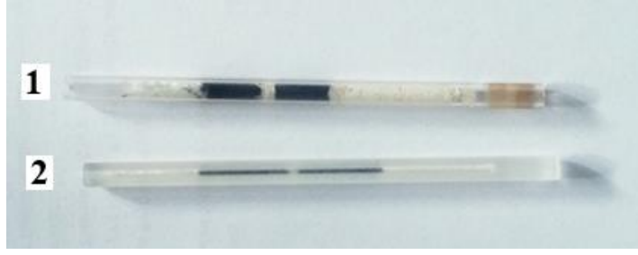
Şekil 4.5 : Sorbent tüp (1) ve odaklama tüpü (2).
