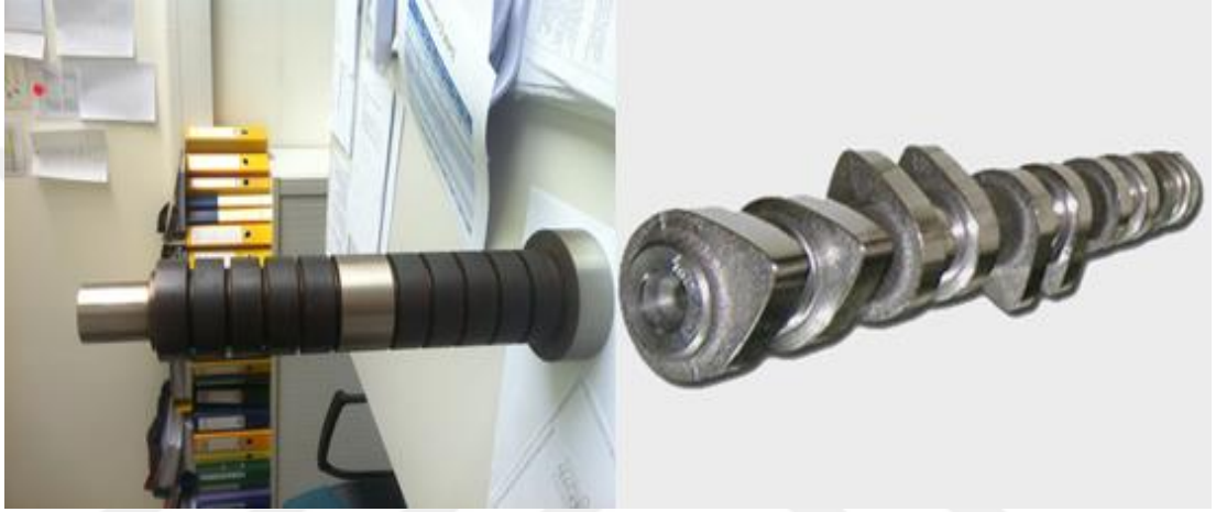
Şekil 7.1: a)Deneylerde kullanılan işparçası b)Kam mili.
