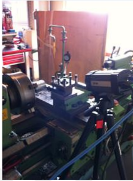
Şekil 6.1 : Manuel tornada sıcaklık ölçümü.
