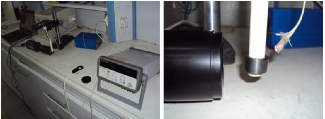
Şekil 6.9 : Emissivite kalibrasyonu deney düzeneği.
