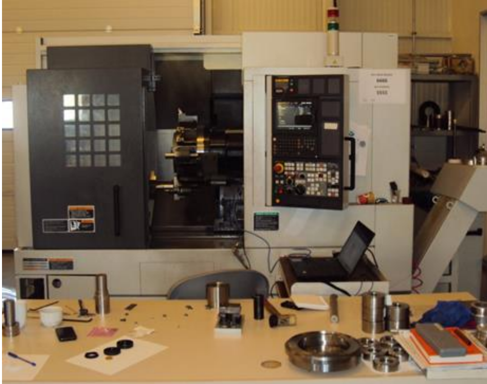
Şekil 6.2 : Dik kesme deneylerinde kullanılan CNC torna.
