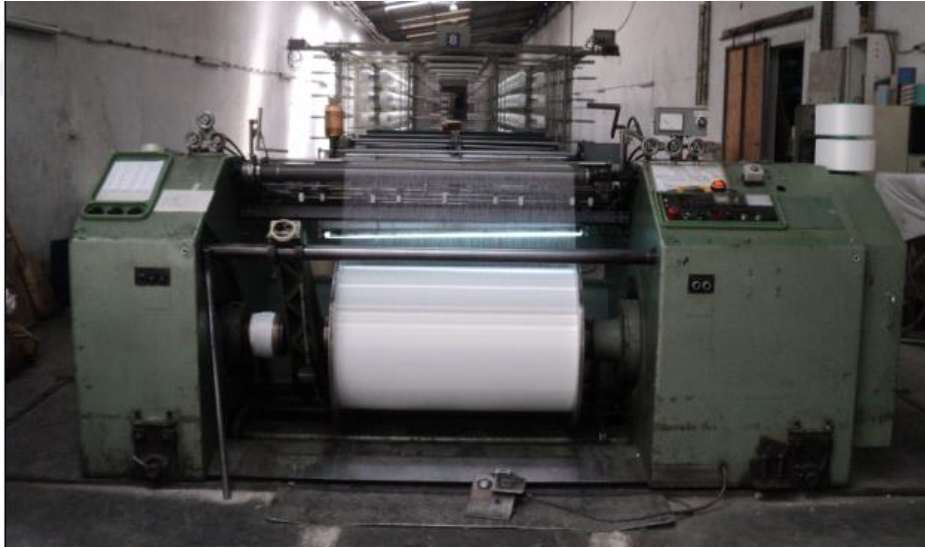
Şekil 1.20. Çözümlü ipliklerinin leventlere sarılması
