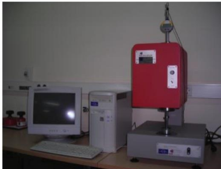
Şekil 3.13. Dijital tekstil kalınlık ölçüm cihazı
