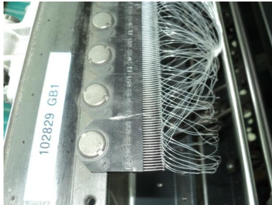
Şekil 3.7. İplik kılavuzundan geçirilmiş iplikler
