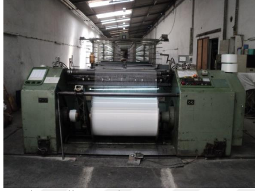
Şekil 3.5. İpliklerin çözü levendine sarılması
