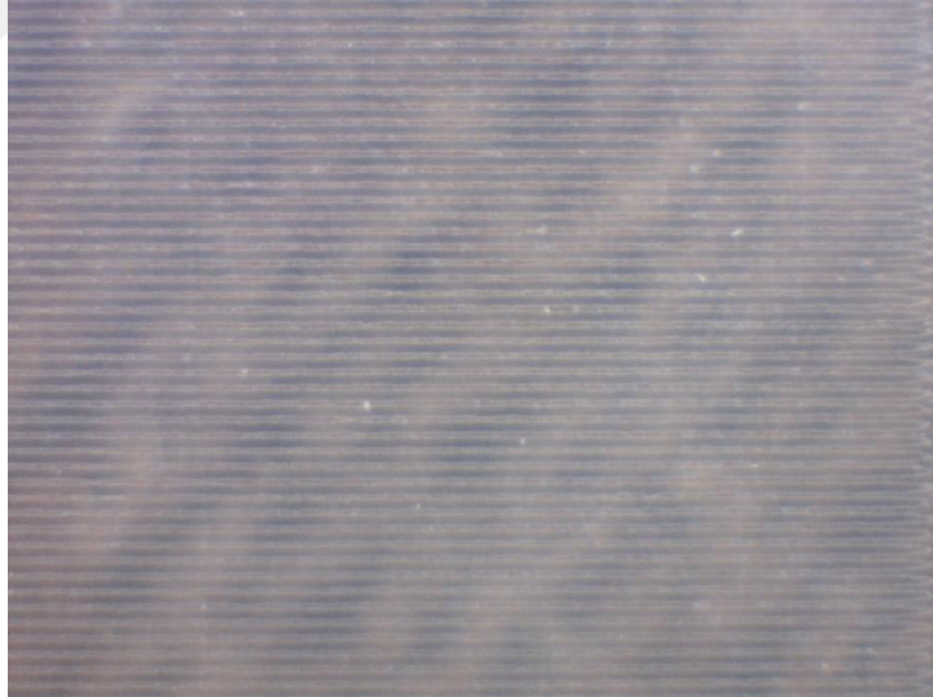
Şekil 5-12 Lazer ile işlenmiş örnek (PN 44)(100 x optik mikroskop ile alınmıştır)
