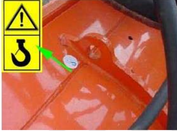
Şekil 4.64 Diskli tırmıkta uygun olarak tasarlanmış ve işaretlenmiş taşıma noktası
