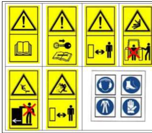
Şekil 4.27 Kulalı pullukta bulunması gereken piktogramlar
