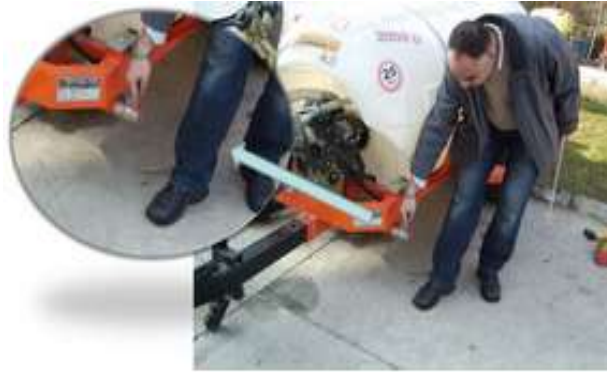
Şekil 4.21 Pülverizatör deposunu boşaltmanın risk oluşturmadığı uygun tasarım
