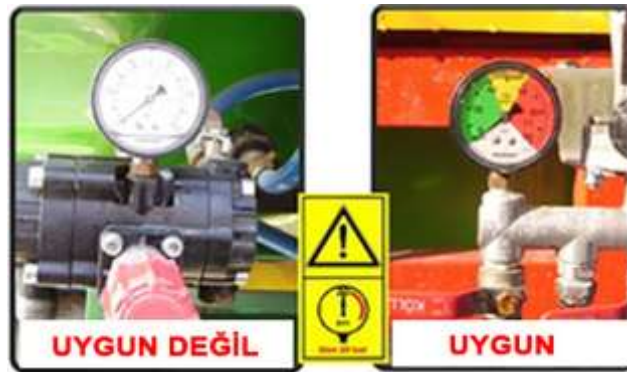
Şekil 4.10 İlaçlama makinesinde izin verilen maksimum basınç değeri (uygun olmayan ve uygun olan)
