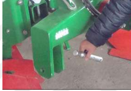
Şekil 4.61 Diskli tırmıkta uygun olarak makineye sabitlenmemiş pim
