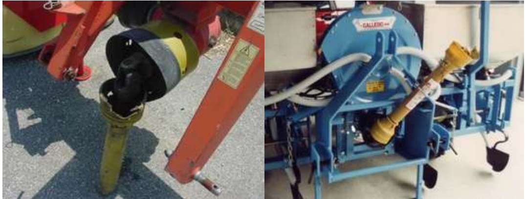
Şekil 4.15 Üzerinde şaft için destek bulunmayan ve bulunan pülverizatör
