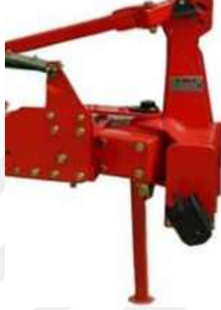
Şekil 4.93 Toprak frezesi üzerinde bulunması gereken dayama ayağı
