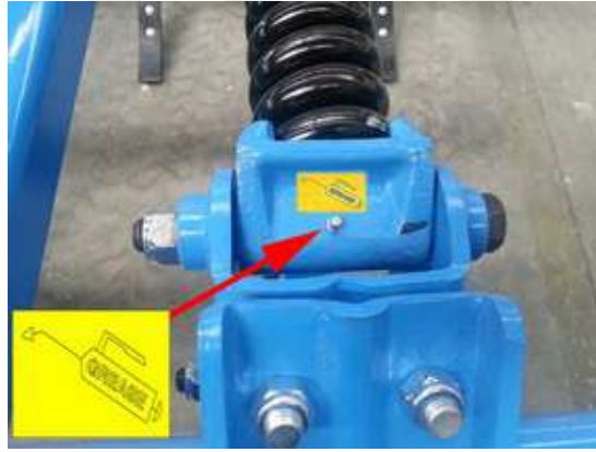
Şekil 4.52 Çizelde yağlama noktasını makine üzerinde gösteren uygun tasarım
