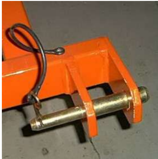
Şekil 4.42 Kazayağı kültüvatörde uygun sabitlenmiş pim
