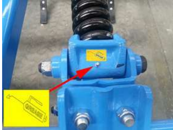
Şekil 4.58 Dişli tırmıkta yağlama noktasını gösteren uygun tasarım
