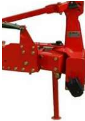
Şekil 4.35 Diskli pulluk üzerinde bulunması gereken dayama ayağı
