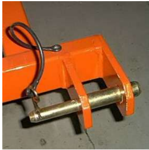
Şekil 4.90 Toprak frezesinde makineye sabitlenmiş pim
