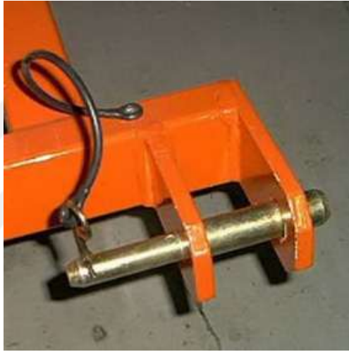
Şekil 4.48 Dipkazanda ayrılmayacak şekilde sabitlenmiş olan pim
