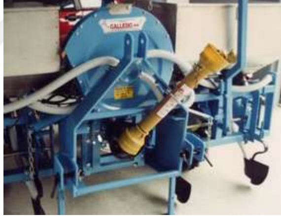
Şekil 4.88 Park etmiş frezede şaft için uygun bir destek tertibatı
