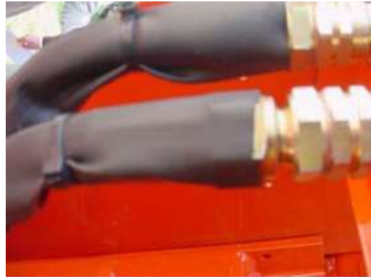
Şekil 4.69 Diskli tırmıkta hortumlar için uygun koruma
