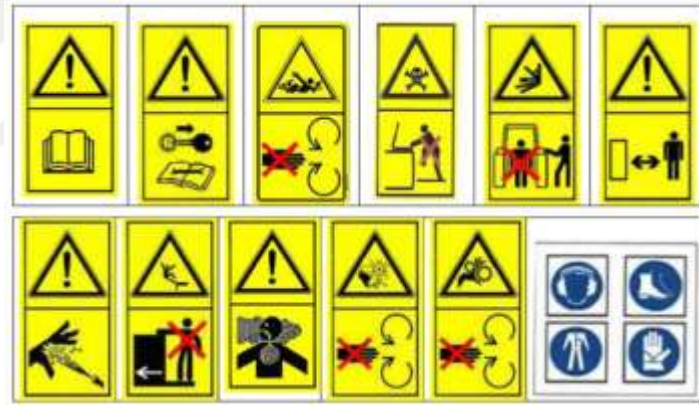
Şekil 4.3 İlaçlama makinesinde bulunması gereken güvenlikle ilgili temel piktogramlar
