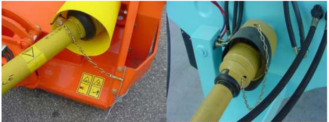
Şekil 4.97 Sap parçalama makinesinde şaft zinciri için bağlama noktası
