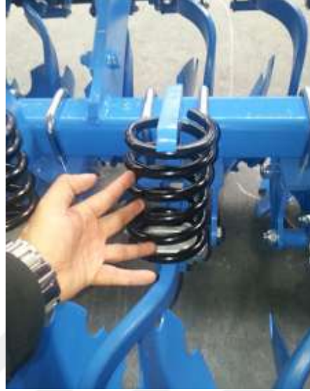
Şekil 4.45 Kültüvatörde koruma olmayan yaylar
