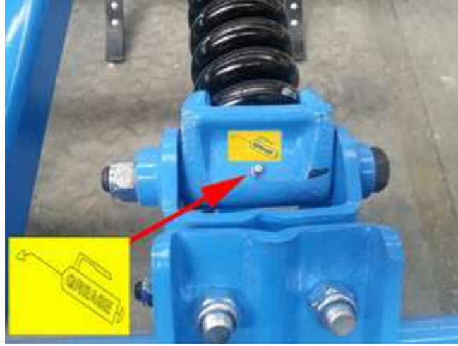
Şekil 4.113 Ara çapa makinesinde yağlama noktasını gösteren uygun tasarım
