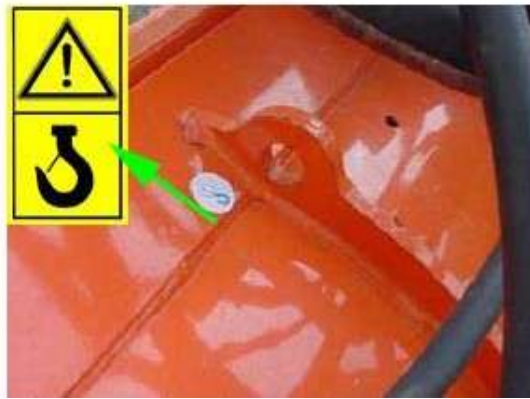
Şekil 4.44 Kültüvatörde uygun olarak tasarlanmış ve işaretlenmiş taşıma noktası
