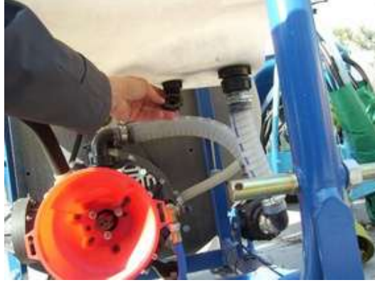
Şekil 4.22 Pülverizatörde operatörle sıvı teması riskine neden olan uygun olmayan tasarım
