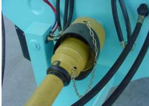
Şekil 4.5 İlaçlama makinesi şaftı zincirinin makine üzerindeki bağlantı noktası
