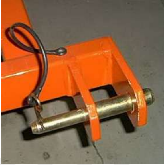
Şekil 4.100 Sap parçalama makinesinde makineye sabitlenmiş pim
