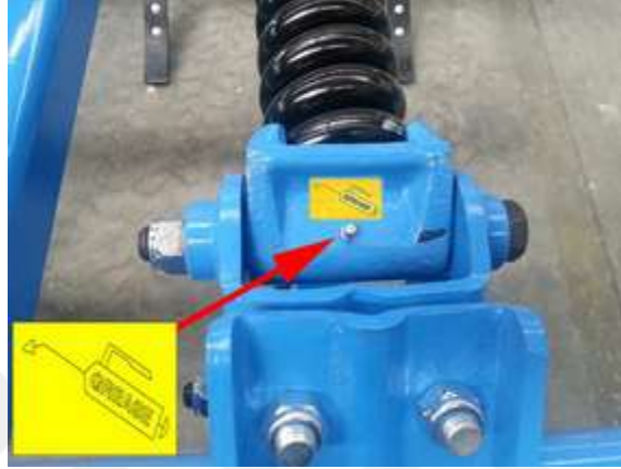
Şekil 4.70 Diskli tırmıkta yağlama noktasını gösteren uygun tasarım
