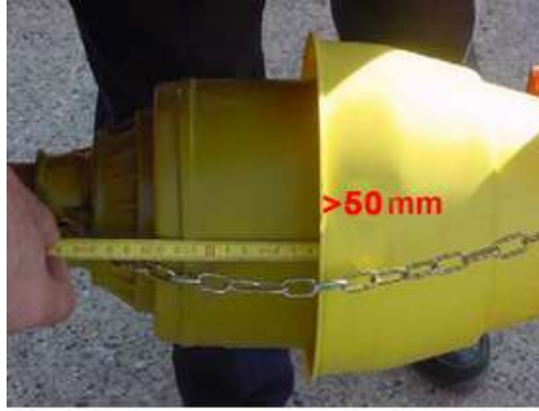
Şekil 4.4. İlaçlama makinesi şaftında uygun örtme payına sahip tasarım
