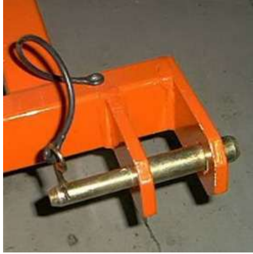
Şekil 4.78 Rototillerde ayrılmayacak şekilde makineye sabitlenmiş pim
