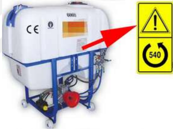
Şekil 4.7 İlaçlama makinesi üzerinde şaft dönüş yönü ve devri işareti
