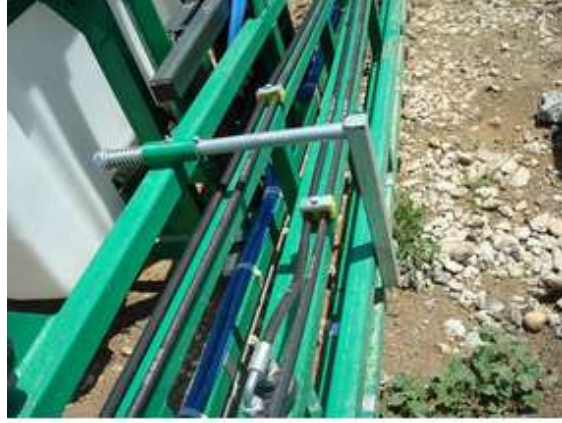
Şekil 4.2 Bumların açılmasını önleyen mekanik bir düzenek
