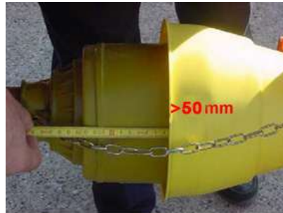
Şekil 4.13 Pülverizatörde uygun örtme payına sahip bir tasarım
