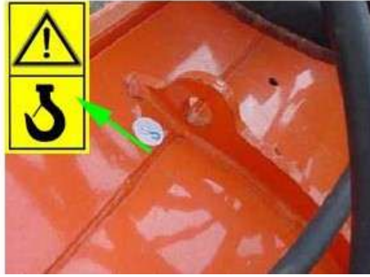
Şekil 4.50 Dipkazanda uygun olarak tasarlanmış ve işaretlenmiş taşıma noktası
