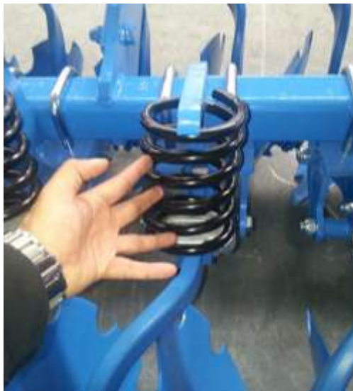
Şekil 4.37 Diskli pulluk üzerindeki korumasız yaylar
