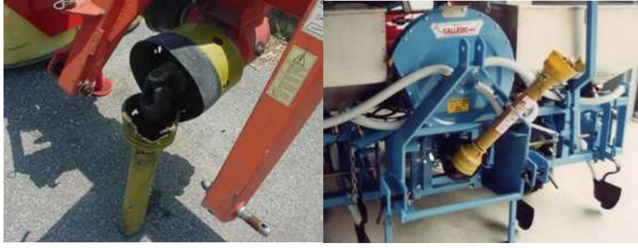
Şekil 4.6 Şaft için destek bulunmayan ve bulunan ilaçlama makinesi
