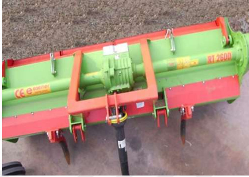
Şekil 4.110 Ara çapa makinesinde dönen bıçakları örten üst koruyucu
