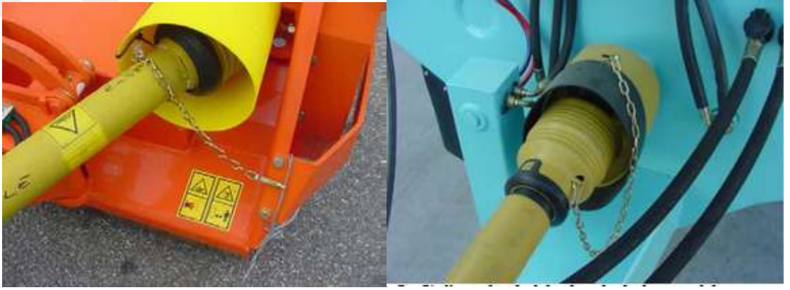
Şekil 4.105 Ara çapa makinesi şaft zinciri için makine üzerindeki bağlama noktası
