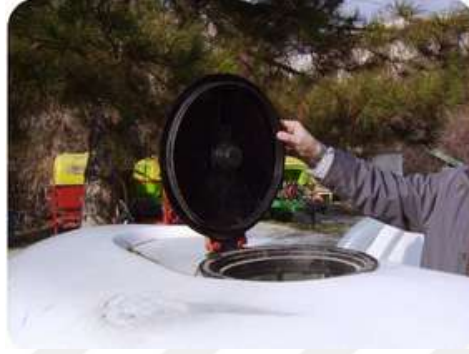
Şekil 4.11 İlaçlama makinesinde makineden ayrılmayacak şekilde tasarlanmış depo kapağı
