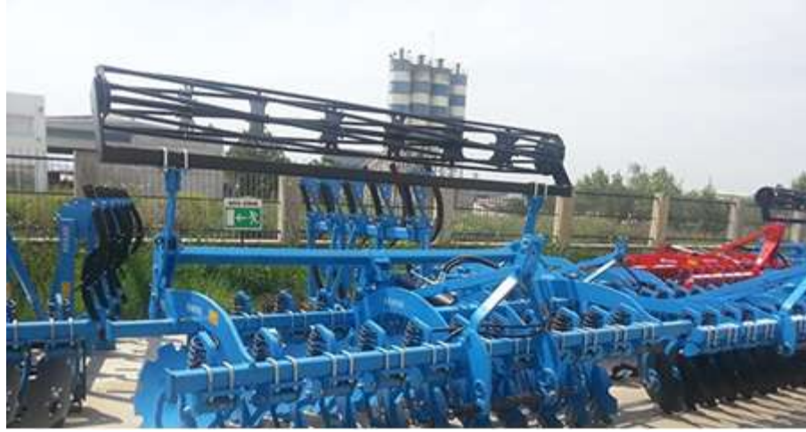
Şekil 4.82 Rototillerde yükseltilmiş merdaneyi sabitleyen sistem
