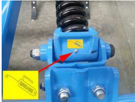
Şekil 4.83 Rototillerde yağlama noktasını gösteren uygun tasarım
