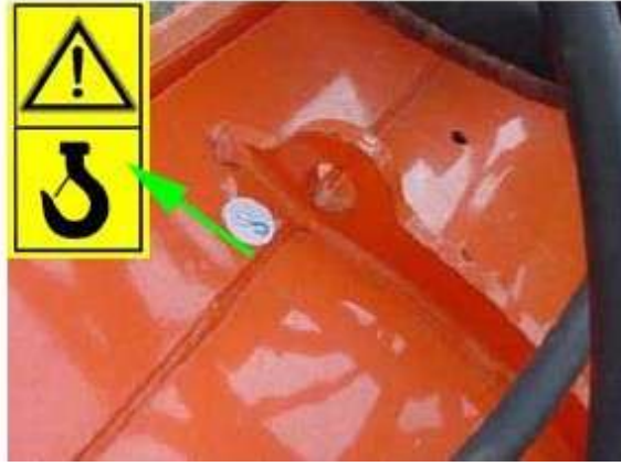
Şekil 4.55 Dişli tırmıkta uygun tasarlanmış ve işaretlenmiş taşıma noktası
