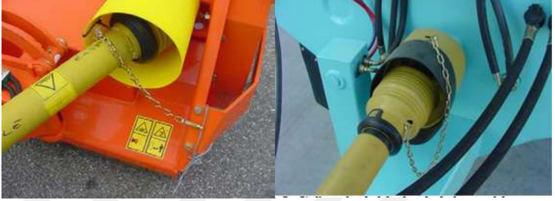
Şekil 4.74 Rototillerde şaft zinciri için makine üzerinde bağlama noktası
