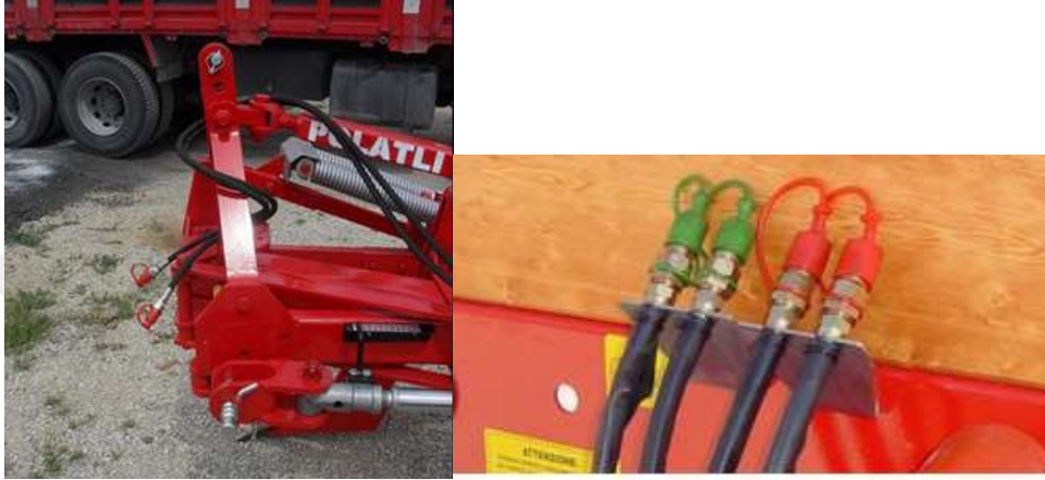
Şekil 4.38 Diskli pulluk üzerindeki hortumlar için uygun olmayan ve uygun tasarımlar
