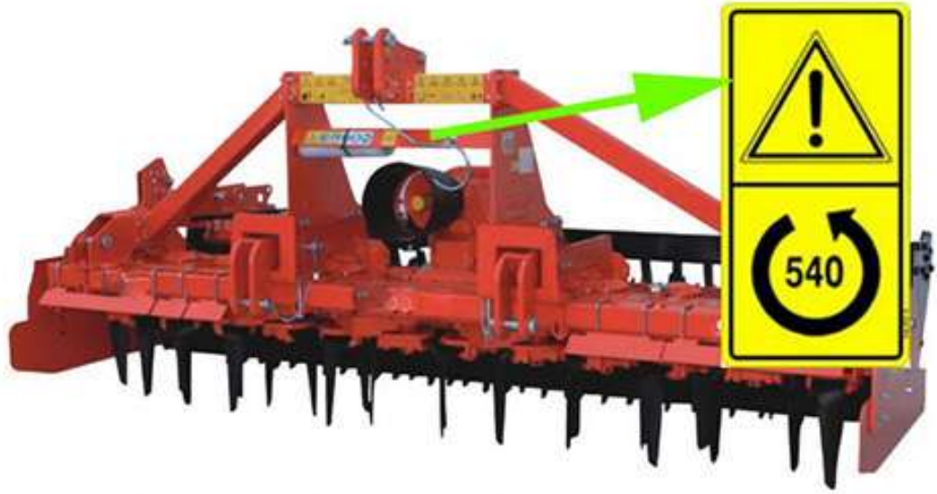
Şekil 4.108 Şaft dönüş yönü ve devri üzerinde işaretlenmiş ara çapa makinesi
