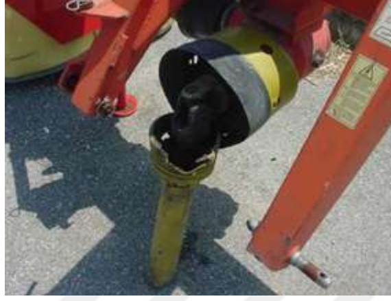
Şekil 4.87 Şaft desteği bulunmayan toprak frezesi
