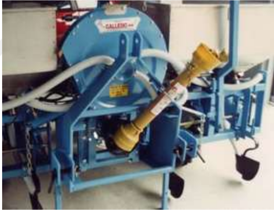
Şekil 4.107 Park etmiş ara çapa makinesinde şaft için uygun bir destek tertibatı
