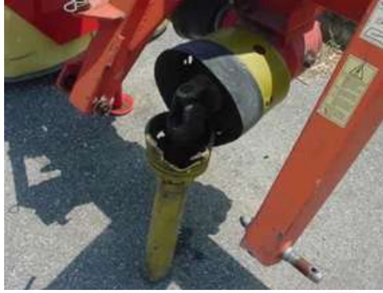
Şekil 4.106 Üzerinde şaft için destek bulunmayan ara çapa makinesi
