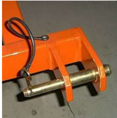
Şekil 4.25 Ayrılmayacak şekilde kulaklı pulluğa sabitlenmiş pimler
