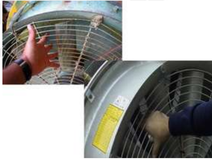
Şekil 4.17 Pülverizatörde uygun koruma altına alınmamış açıklıklar
