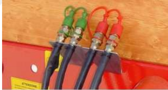
Şekil 4.103 Sap parçalama makinesinde hortumlar için uygun tertibat
