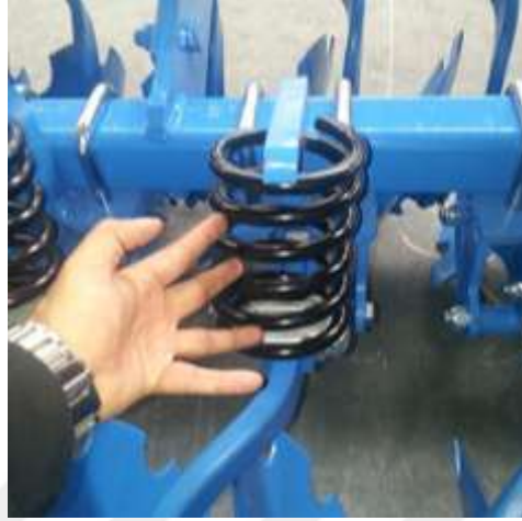
Şekil 4.66 Diskli tırmık üzerindeki korumasız yaylar
