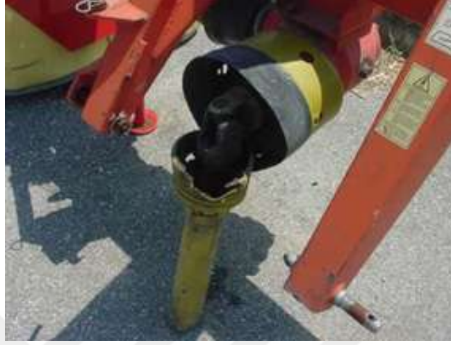
Şekil 4.98 Üzerinde şaft için destek bulunmayan sap parçalama makinesi
