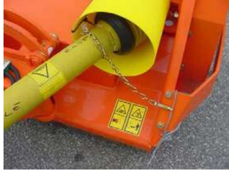
Şekil 4.14 pülverizatör şaftı zincir için makine üzerindeki bağlantı noktası
