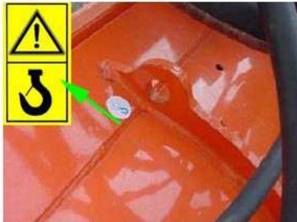
Şekil 4.92 Toprak frezesinde uygun olarak tasarlanmış ve işaretlenmiş taşıma noktası
