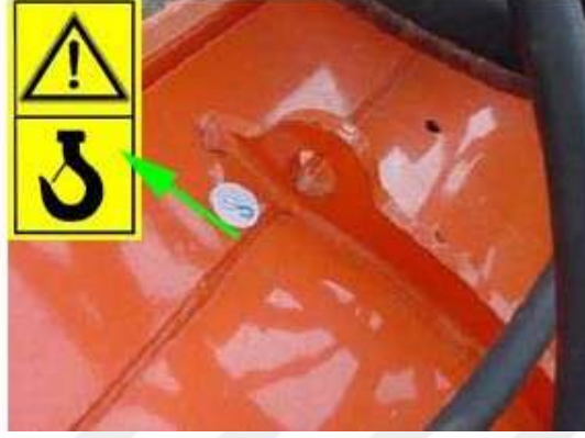
Şekil 4.34 Diskli pullukta uygun olarak tasarlanmış ve işaretlenmiş taşıma noktası
