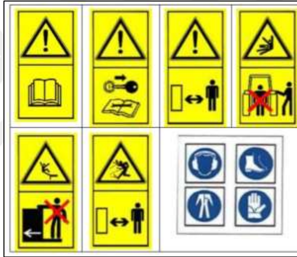
Şekil 4.54 Dişli tırmıkta bulunması gereken piktogramlar
