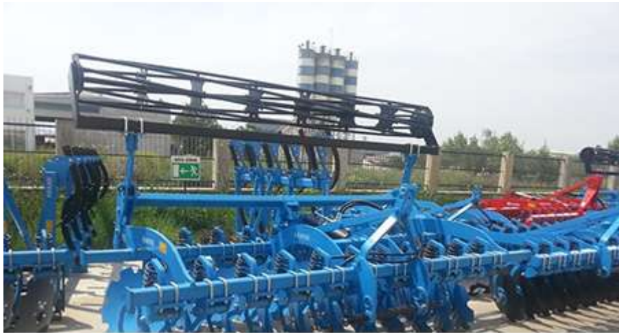
Şekil 4.65 Diskli tırmıkta yükseltilmiş merdanenin düşmesini engelleyici sistem
