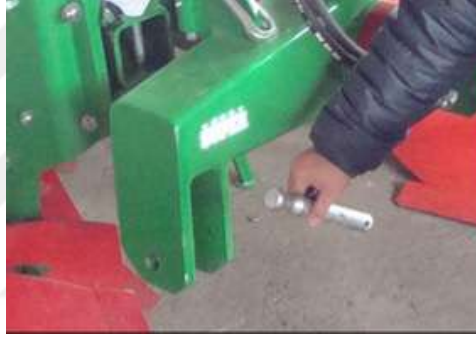
Şekil 4.79 Rototillerde uygun olarak makineye sabitlenmemiş pim
