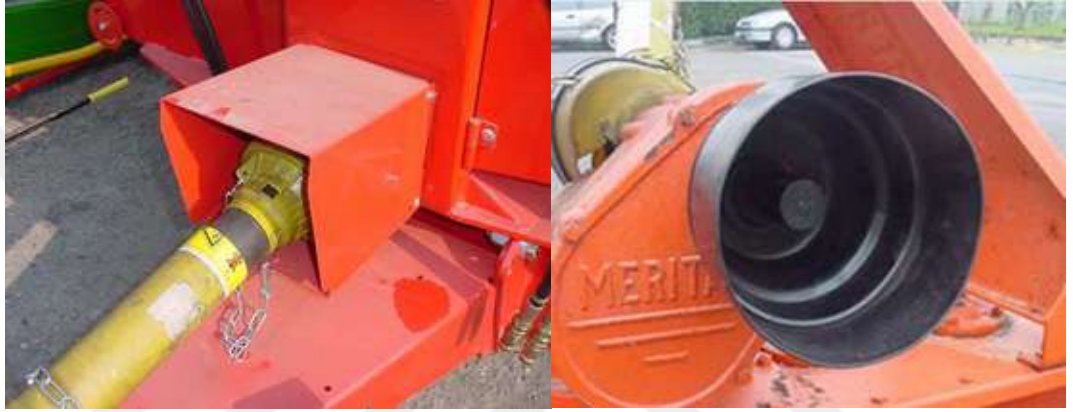
Şekil 4.72 Rototillerde uygun tasarlanmış güç girişi muhafazası
