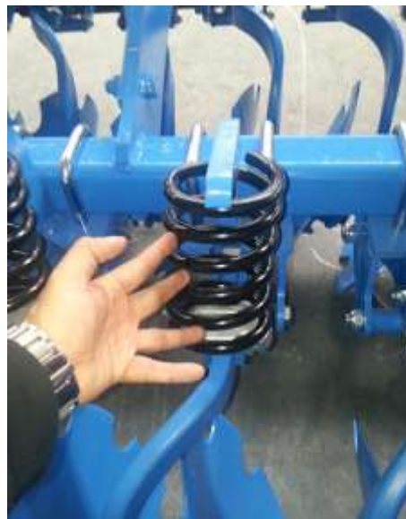
Şekil 4.31 Kulaklı pulluk üzerindeki korunmasız yaylar
