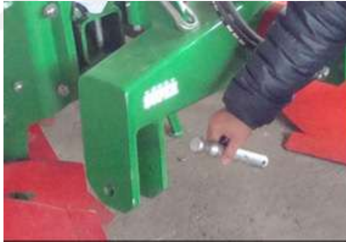
Şekil 4.101 Sap parçalama makinesinde uygun olarak makineye sabitlenmemiş pim
