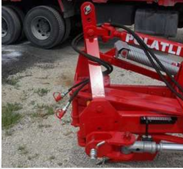
Şekil 4.102 Sap parçalama makinesinde hortumlar için uygun olmayan tasarım
