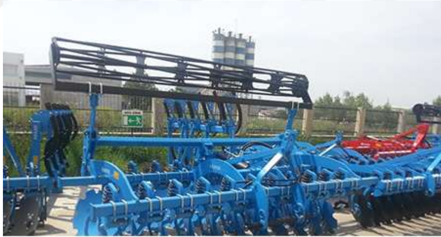
Şekil 4.56 Dişli tırmık arkasındaki yükseltilmiş merdane için düşme engelleyici
