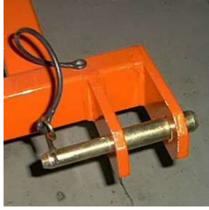
Şekil 4.60 Diskli tırmıkta makineye sabitlenmiş pimler
