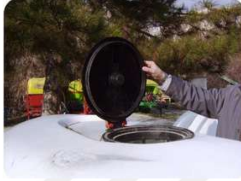
Şekil 4.20 Depo kapağının pülverizatörden ayrılmayacak bağlantısı
