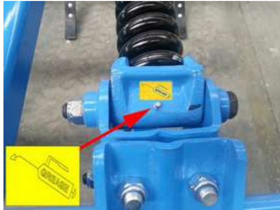
Şekil 4.94 Toprak frezesinde yağlama noktasını gösteren uygun tasarım
