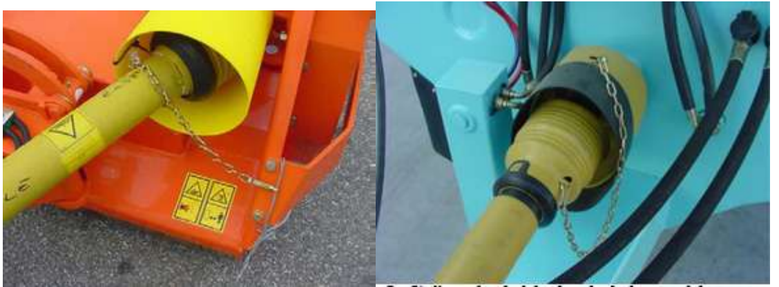
Şekil 4.86 Toprak frezesinde şaft zinciri için bağlama noktası
