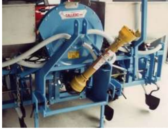
Şekil 4.76 Park halindeki rototillerde uygun şaft destek tertibatı
