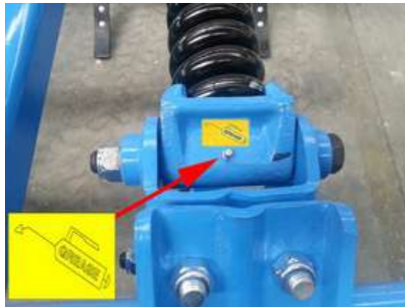
Şekil 4.46 Kültüvatörde yağlama noktasını gösteren uygun tasarım
