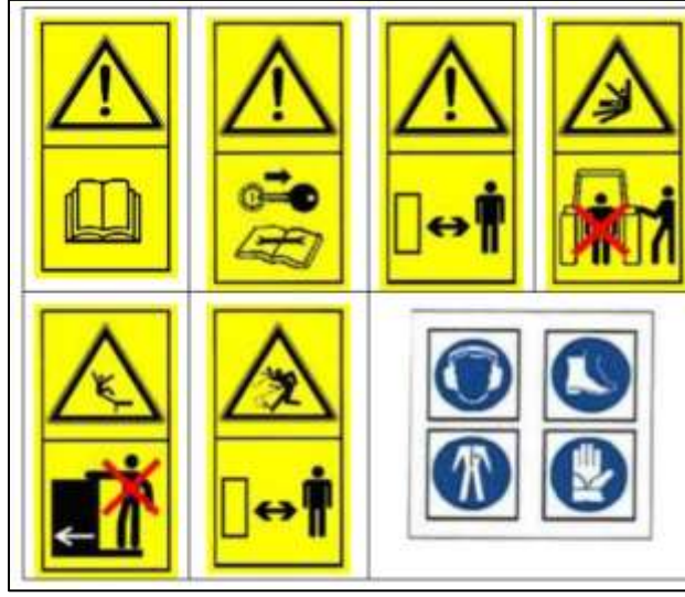
Şekil 4.62 Diskli tırmıkta bulunması gereken piktogramlar
