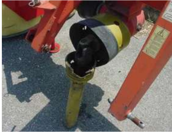
Şekil 4.75 Şaft için destek bulunmayan rototiller
