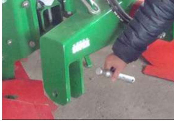
Şekil 4.91 Toprak frezesinde uygun olarak makineye sabitlenmemiş pim
