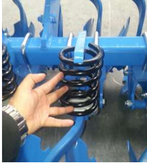
Şekil 4.57 Dişli tırmık üzerindeki korumasız yaylar
