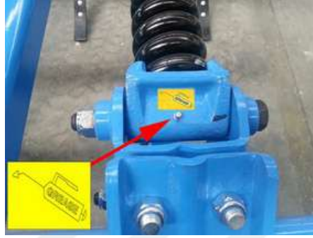
Şekil 4.40 Diskli pullukta yağlama noktasını gösteren uygun tasarım
