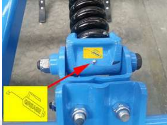
Şekil 4.32 Kulaklı pullukta yağlama noktasını gösteren uygun tasarım
