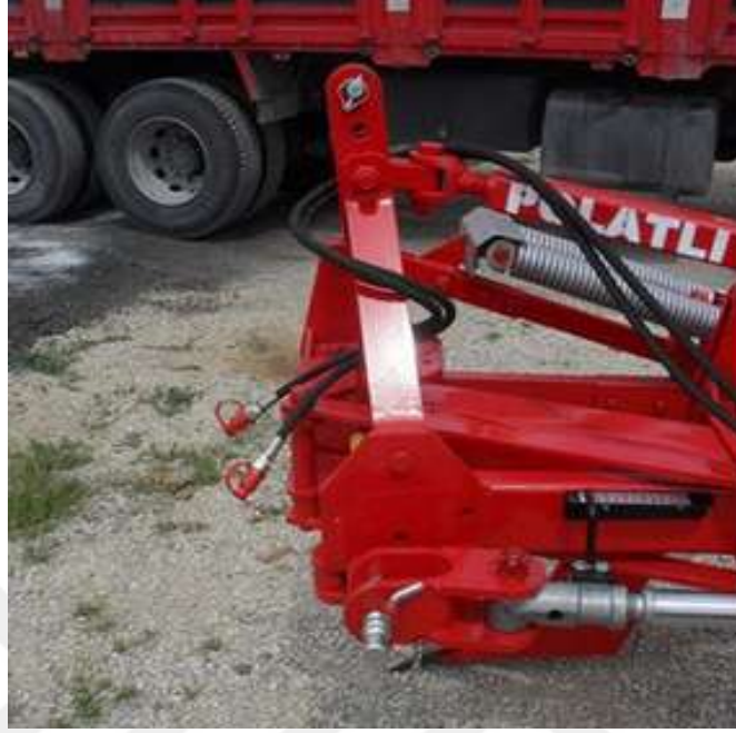
Şekil 4.68 Diskli tırmıkta hortumlar için uygun olmayan tasarım
