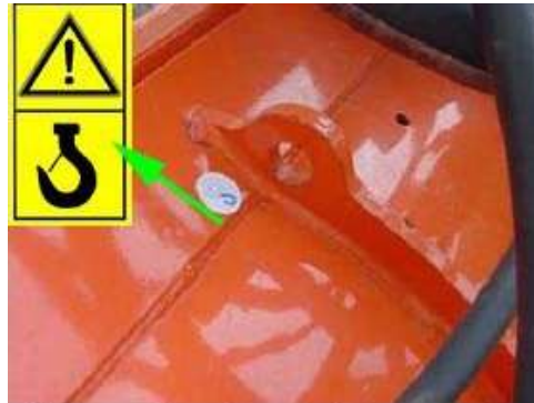
Şekil 4.29 Kulaklı pullukta uygun olarak tasarlanmış ve işaretlenmiş taşıma noktası
