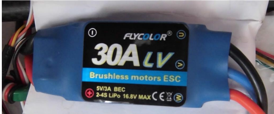
Resim 3.7 Flycolor marka 30A LV Fırçasız motor ESC.
