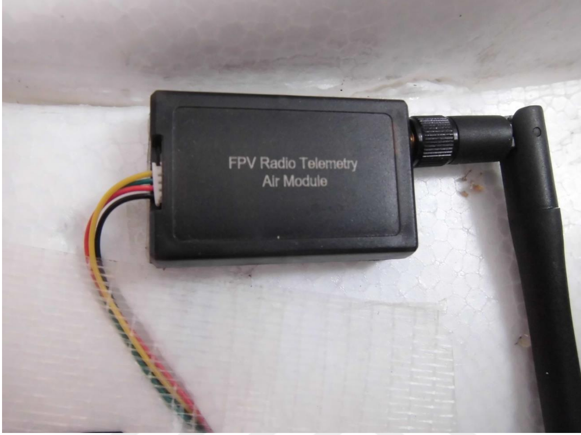
Resim 3.2 FPV Radio telemetri kiti.
