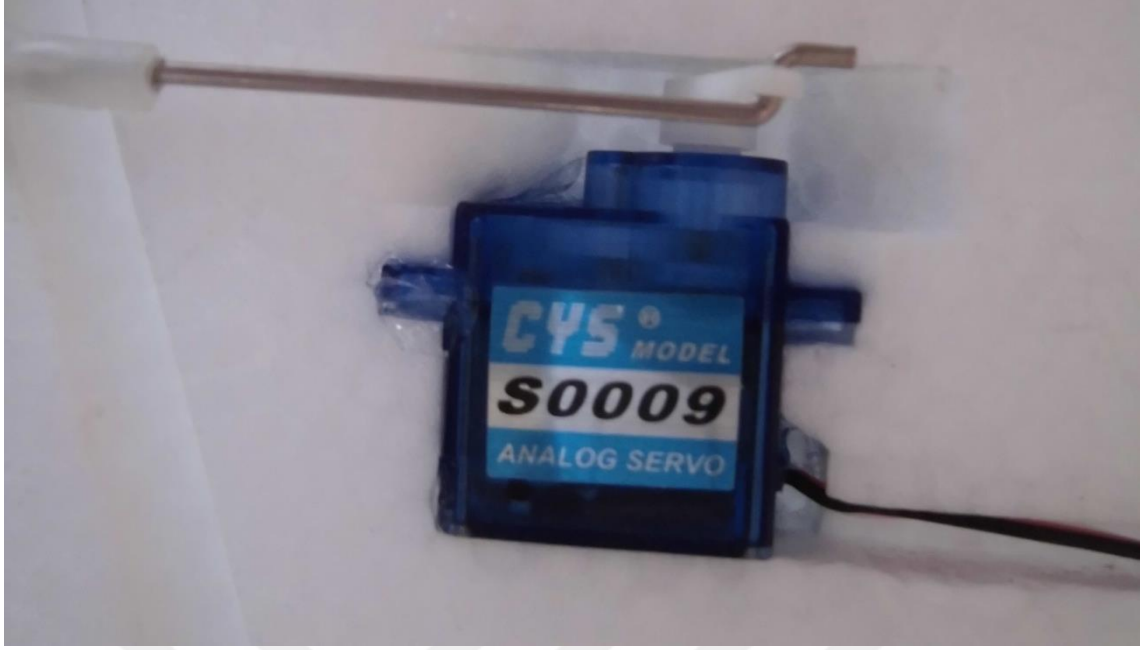
Resim 3.4 CYS S0009 analog servo motor.
