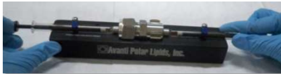
Şekil 2.6 Extruderden geçirilerek eritrosit membran veziküllerinin oluşturulması.
