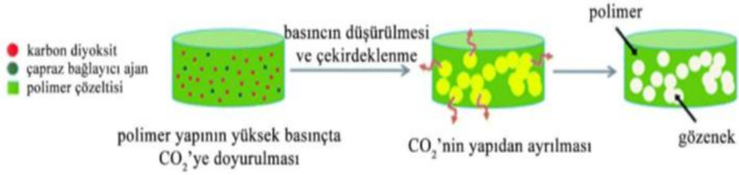
Şekil 2. 7 CO 2 kullanımı ile gaz köpüklendirme yönteminin şematik gösterimi[36]
