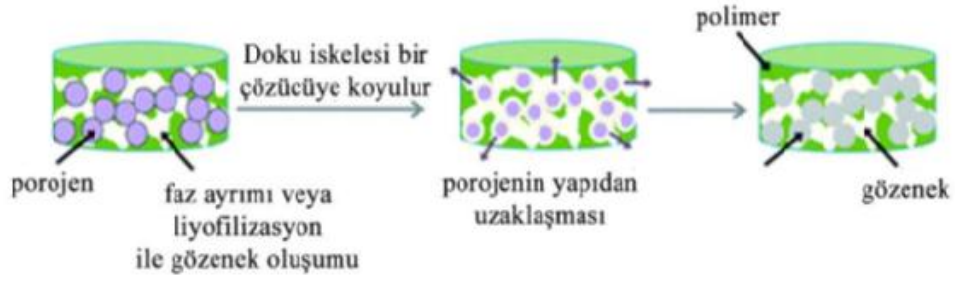
Şekil 2. 5 Çözücü dökümü-parçacık uzaklaştırma yönteminin şematik gösterimi[36]
