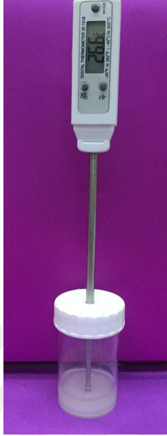
Şekil 3. 8 Reaksiyon esnasındaki sıcaklık değişimini ölçmek amacıyla vial içerisine yerleştirilmiş prob termometreye ait görüntü
