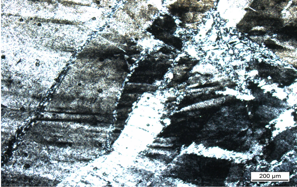
Şekil 3.9. İri kristalli çubuksu baritlerin mikroskoptaki görünümü (çift nikol).
