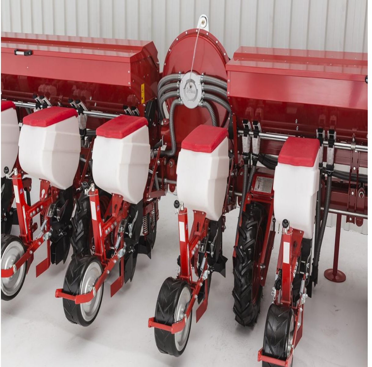
Şekil 2. Baltalı Tip Ekim Makinası (katalog)
