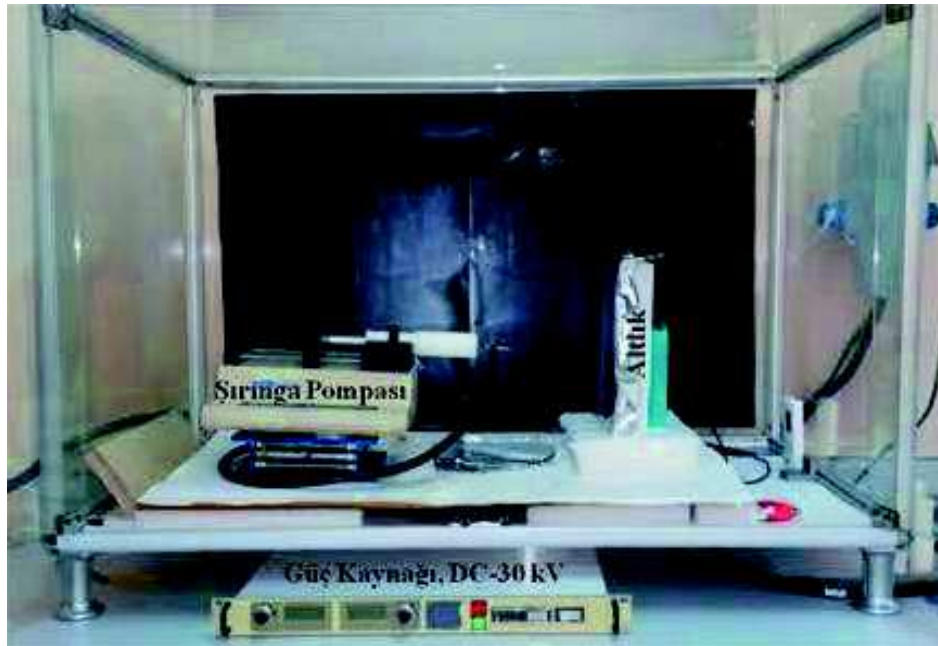
Şekil 3.7: Elektro-eğirme düzeneğinin resmi
