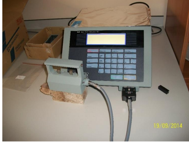
Ek Şekil 16. Patates Kabuğundan Elde Edilen PU Köpüklerin Isı İletkenlik Katsayısının Ölçülmesi
