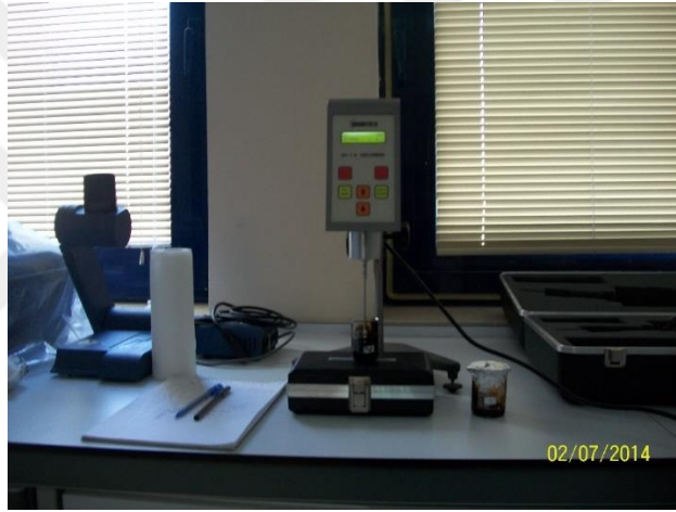
Ek Şekil 14. Patates Polyolünün Viskozitesinin Ölçülmesi.
