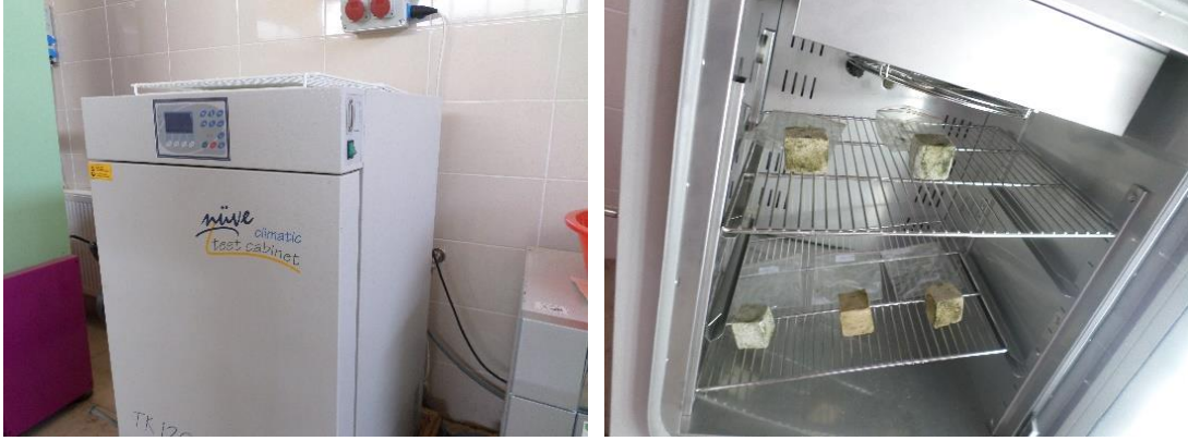
Ek Şekil 19. Patates Kabuğundan Elde Edilen PU Köpüklerin Mekanik Testleri ve Yoğunluk Ölçümü İçin İklimlendirilmesi Görüntüsü.
