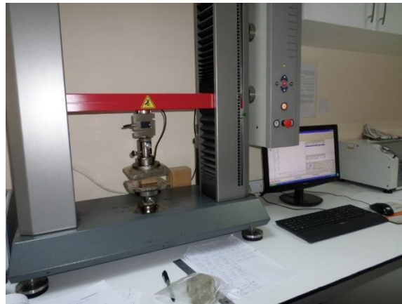
Ek Şekil 18. Patates Kabuğundan Elde Edilen PU Köpüklerin Basınç Testlerinin Yapılması Görüntüsü.
