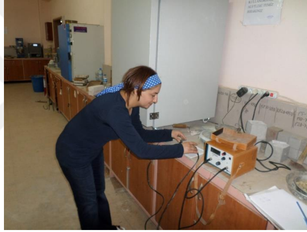
Ek Şekil 17. Patates Kabuğundan Elde Edilen PU Köpüklerin Ses İletim Hızı Ölçümü Görüntüsü.
