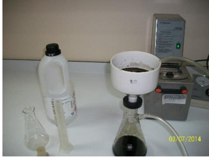
Ek Şekil 10. Sıvılaşmayan Patates Ögesi Miktarının Belirlenmesi
