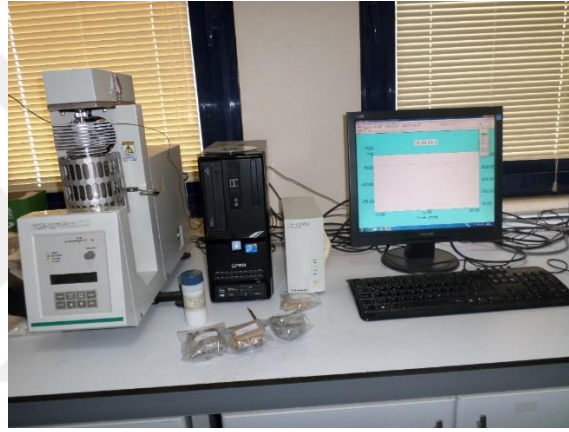
Ek Şekil 20. Patates Kabuğundan Elde Edilen PU Köpüklerin TGA Analizinin Görüntüsü.
