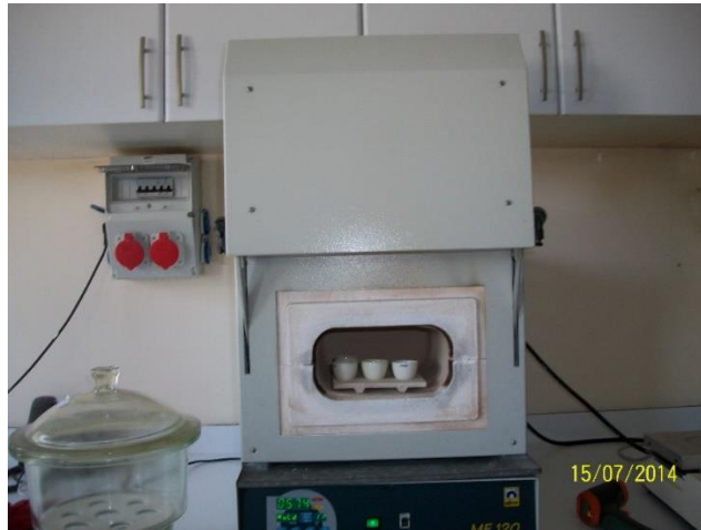
Ek Şekil 9. Patates Öğelerinin Kül Testi Görünümü
