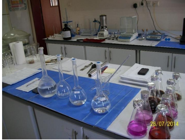
Ek Şekil 13. Sıvılaştırılmış Patates Öğelerine Ait Polyollerin Asit ve Hidroksil Değerlerinin Belirlenmesi Testinin Görünümü
