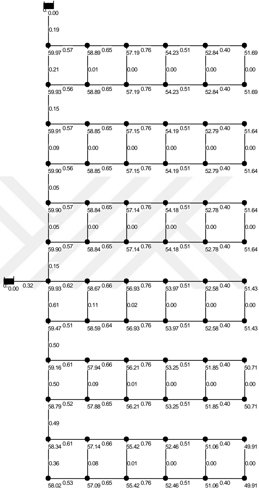
Şekil 4.8: H4 Sisteminin Akım Hızları ve Basınçları
