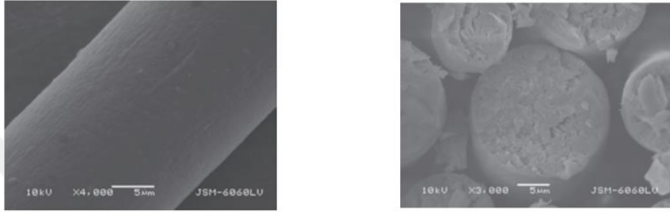
Şekil 2.5: Yerfıstığı proteinlerinden olan ardil lifleri'nin SEM görüntüleri (ICI Şirketi) (Rijavec ve Zupin 2011).
