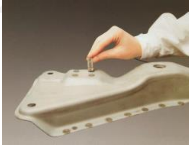
Şekil 3. 33 Manüel Ultrasonik test [9].
