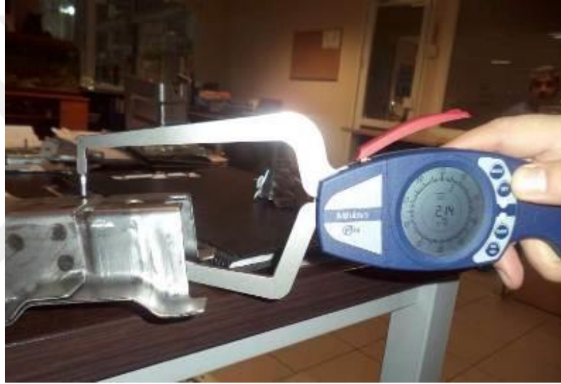
Şekil 3. 22 Saclardaki çökmenin ölçülmesi-1
