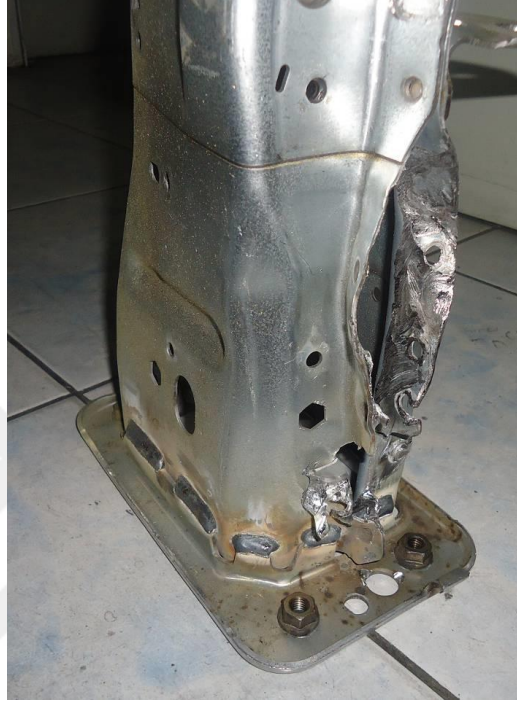
Şekil 3. 24 Teardown yöntemiyle puntaları koparılmış deney parçası
