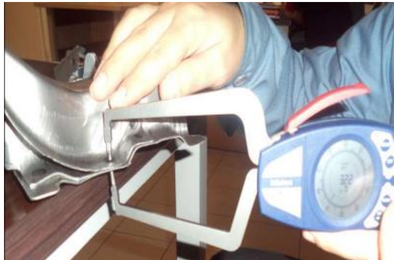
Şekil 3. 23 Saclardaki çökmenin ölçülmesi-2
